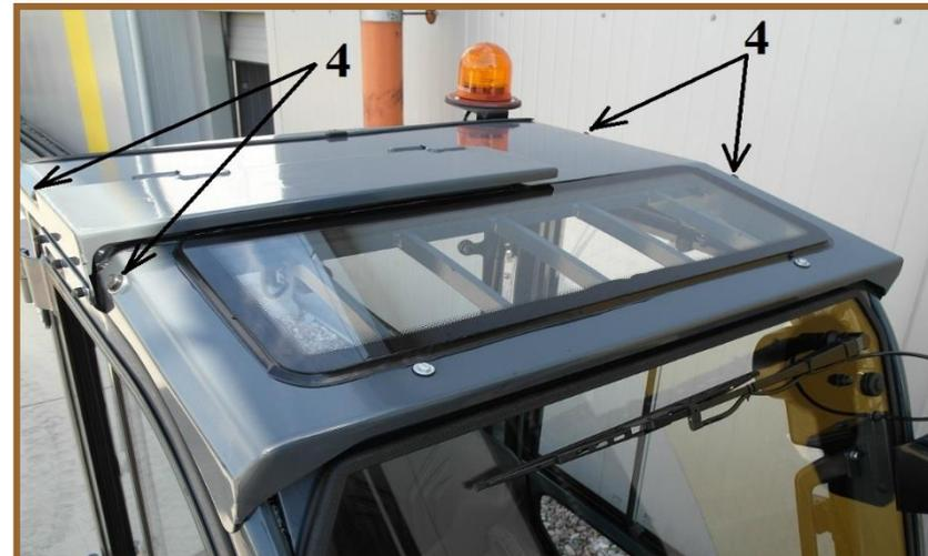
3. Tout en maintenant la traverse avant haute, poser le toit sur le protège conducteur, positionner le toit par rapport à la découpe de la trappe d'accès aux batteries (2) et en faisant coïncider les trous à l'avant du toit avec ceux de la traverse avant haute (3)
