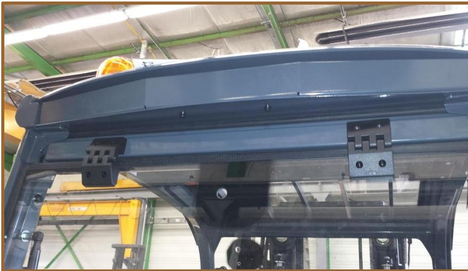
6. Positionner la vitre contre le protège conducteur et de façon que le joint vienne plaquer contre la traverse haute (1). Maintenir la vitre en cette position à l'aide d'une sangle
