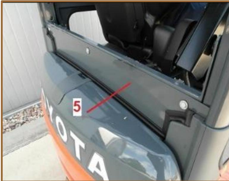
13. Positionner la tôle basse (5) contre la traverse 4 et veiller à répartir l'adhérence du joint entre la tôle et le contrepois du chariot.
