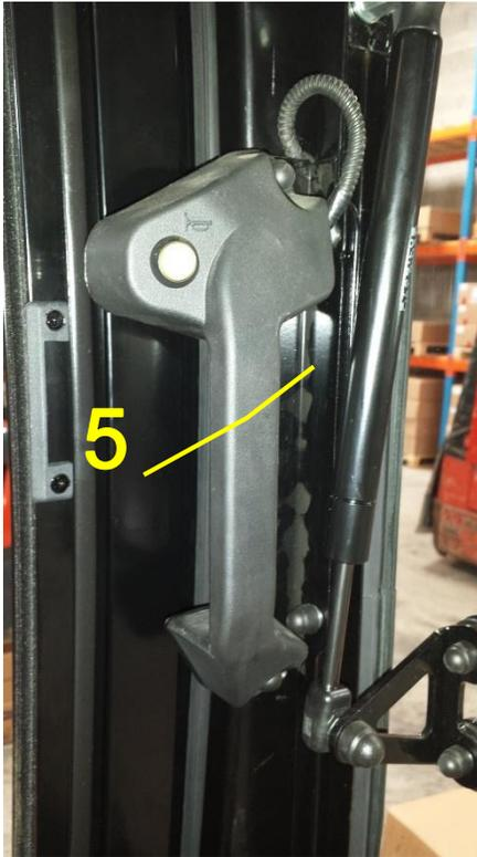
6. Fixer sur le cadre métallique du panneau arrière le support poignée klaxon fourni (5) à l'aide de 2 vis H M6x16 et des rondelles plates
