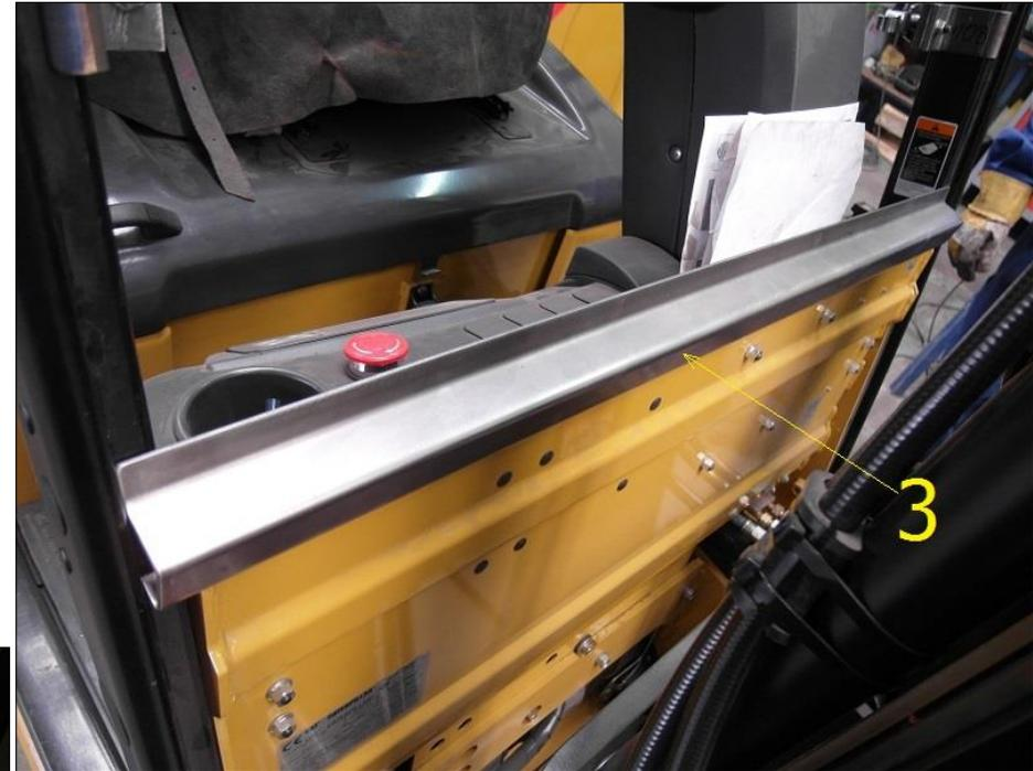
5. Fixer le tableau de bord et la traverse avant basse (3) avec des vis (4) H M6x16 et des rondelles plates
