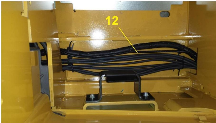
9. Dérouler l'ensemble faisceau électrique et repérer les différents connecteurs des équipements suivant le schéma au point 1
