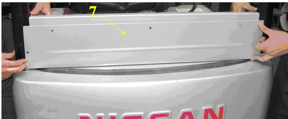
5. Serrer la vitre arrière aux traverses déjà montées et aux cornières, marquer les points pour les trous de montage de la fixation du vitre arrière (8) sur la poutre arrière basse (5). Forer les trous  $\text{\O}11$  et mettre les rivets à jaquette M8. Visser la gâche de la vitre arrière à la traverse arrière basse à l'aide des vis M8x20.
