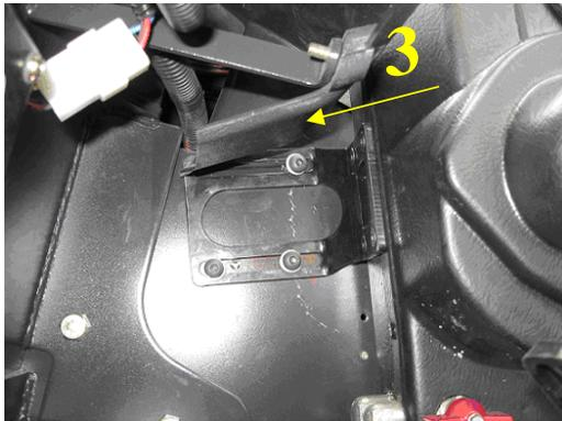
3. Au-dessous des tubes chauffage (4) sur le plancher marquer la place de la coupure du trou (5) pour faire passer les durits de chauffage (6). Le trou coupé doit posséder un tel diamètre pour pouvoir faire passer facilement les durits.
