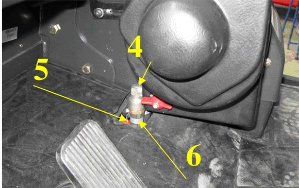
4. Mettre les tuyaux sur les tubulures de la machine à chauffer et serrer à l'aide des bandes.
