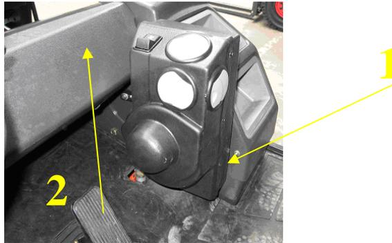
2. Marquer les points pour les trous de montage en utilisant la poignée de fixation (3) sur la tôle du côté gauche du pupitre (1). Forer les trous  $\text{\O}11$  et mettre les rivets à jaquette M8. Visser la poignée chauffage à l'aide des vis M8x20.
