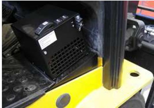
8. Connecter l'alimentation du chauffage indiquée avec un "+" (fil rouge  $4 \text{ mm}^2$ ) sur la prise d'origine (6) (directement sur la batterie)
