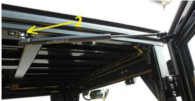
6. Positionner l'ancrage sur l'OHG lorsque l'amortisseur est au « point mort », puis revenir en compression le long du profil OHG. Marquer cette position. Puis avancer cette position sur une distance de 7cm dans la direction de compression de l'amortisseur. Marquer cette position pour le perçage.
