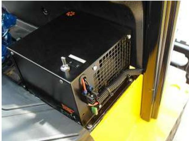
8. Connecter l'alimentation du chauffage indiquée avec un "+" (fil rouge 4 mm<sup>2</sup>) sur la prise d'origine (6) (directement sur la batterie)
