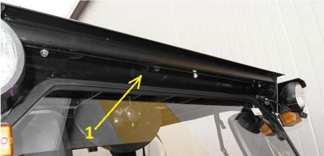
2. Positionner sur barre inférieure sur le profil OHG afin que le pli (2) couvre et soit réparti sur la face avant du cockpit. Puis visser sur la face avant de l'OHG avec des vis auto-perforantes Ø6, 3x25.
