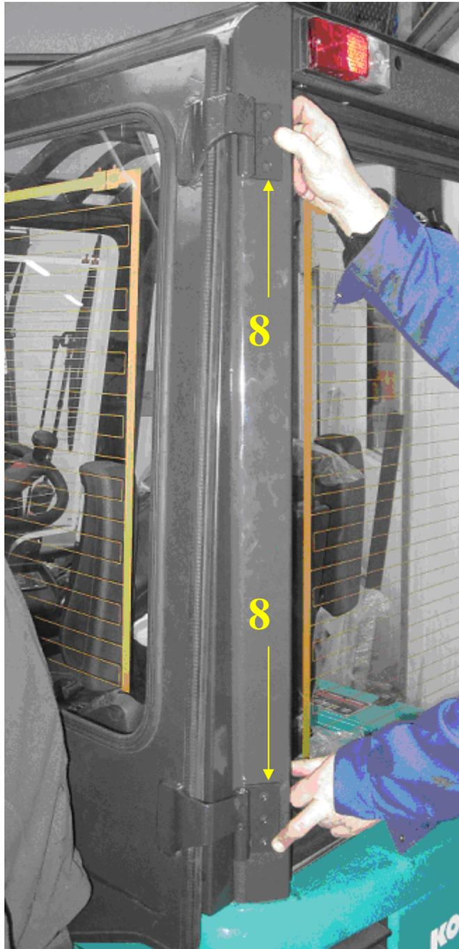
22. Installer l'axe compas sur le cadre de la porte. Sur l'autre bout du compas mettre la poignée ( 9 ).
