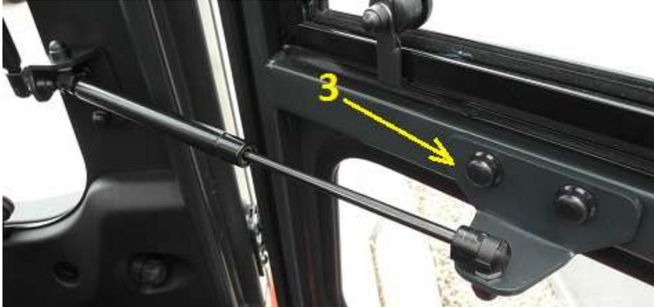
4. La porte fermée, ajuster la position du pied de porte pour réduire l'espacement.
