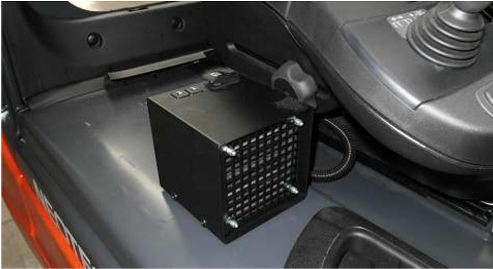
2. Insérer des écrous rivet M6 dans les trous d'origine (positionner sur le contrepois du charriot). Fixer le connecteur (1).
