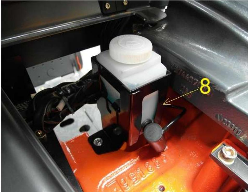
18. Derrière la batterie, marquer les positions pour le perçage des trous d'assemblage du réservoir de lave glace (8). Percer  $\text{Ø}4,8$  aux positions marquées puis tarauder M6.
