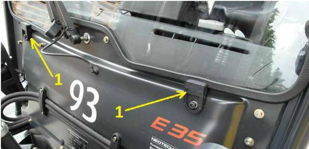
3. Positionner la vitre avant sur les ancrages (1), puis fixer la partie supérieure du panneau avant sur les trous d'origines avec des vis M8x45.
