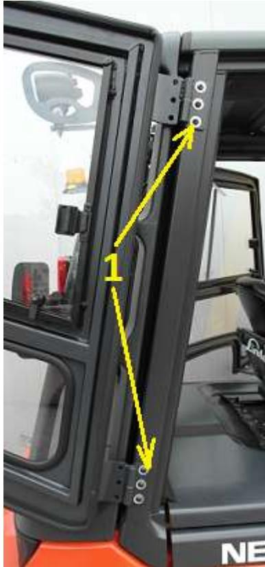
2. Insérer des écrous rivet M8 sur les trous d'origine. Fixer l'ancrage de la serrure (2) avec des vis M8x25.
