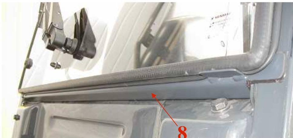
12. Apposer le vitre avec les poignées de fixation sur les profilés avant du cadre du chariot de cette façon pour que le vitre empiète également la tôle supérieure et inférieure et les profilés avant du cadre du chariot. Marquer les points pour les trous de montage en utilisant les poignées de montage (9) sur le cadre du chariot.
