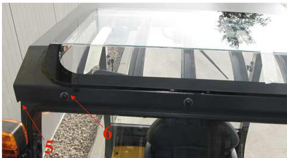
9. Visser la partie arrière du toit à l'aide des clous de Parker  $\text{Ø}6,3 \times 25$ .
