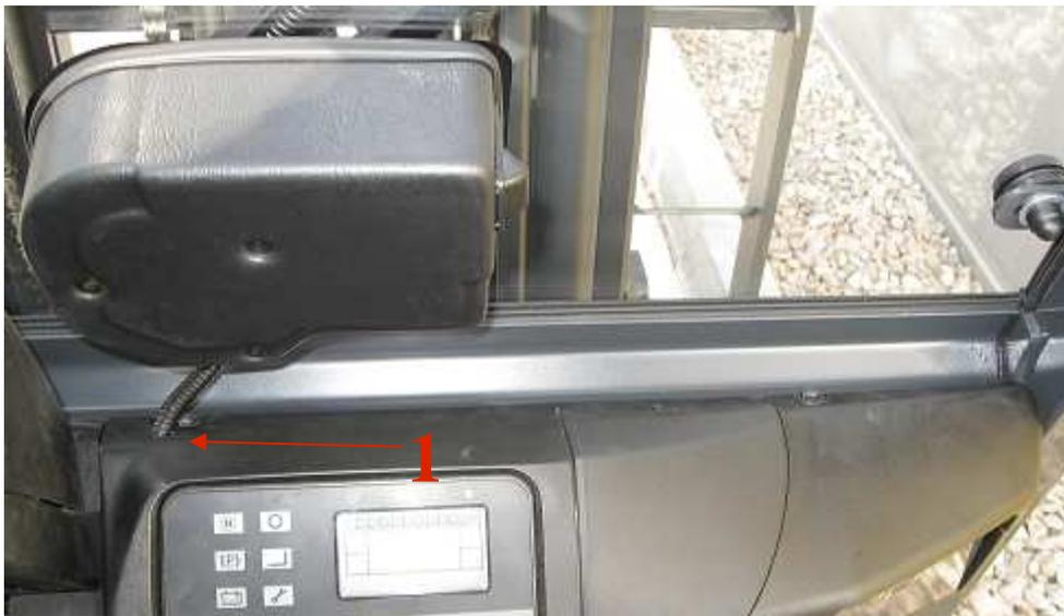
3. Coller la rondelle entretoise (2) sur la vitre arrière à l'aide du silicone et ensuite visser le porte-raclette arrière. Monter le bras et la raclette du porte-raclette arrière. Faire passer le faisceau du porte-raclette arrière par le trou (3) localisé sur la partie intérieure du profilé arrière gauche vers la partie arrière du chariot.
