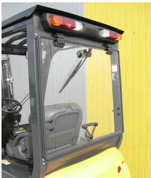
4. Presser le vitre arriere sur le cadre du chariot et marquer les points pour les trous de montage en utilisant l'accroche du vitre arriere (3) sur la poutre arriere inférieure. Forer les trous  $\varnothing 11$  et ensuite mettre les rivets à jaquette M8. Visser l'accroche de la vitre arriere à l'aide des vis M8x20.
