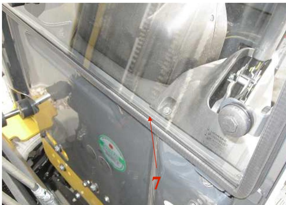
11. Insérer la tôle avant inférieure (8) sous le pupitre dévissé et ensuite visser les vis (7).
