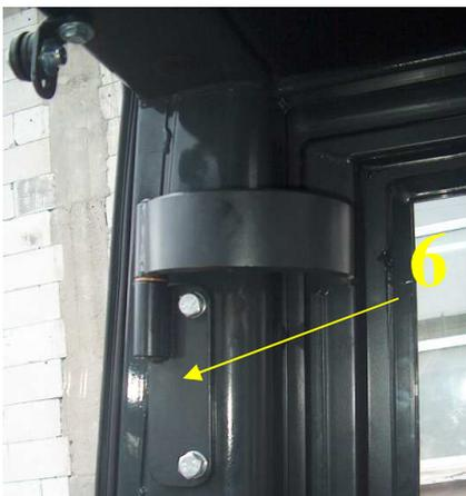
6. Visser la poignée ( 7a ) à la porte à la place des rivets à jaquette. Monter le compas à gaz aux axes sphériques des poignées ( 7 ) et ( 7a ).
