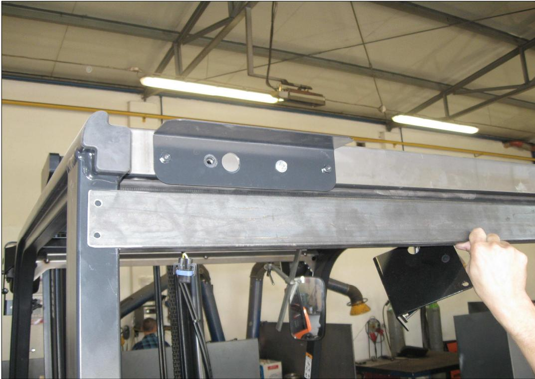
3. Ajuster la **tôle arrière inférieure** sur la partie inférieure du cadre du chariot également avec la surface arrière du cadre de cette façon pour que le joint d'étanchéité s'appuie sur la charge du chariot. Marquer les points du montage du côté intérieur du cadre du chariot, forer les trous pour les rivets à jaquette et visser la poutre.
