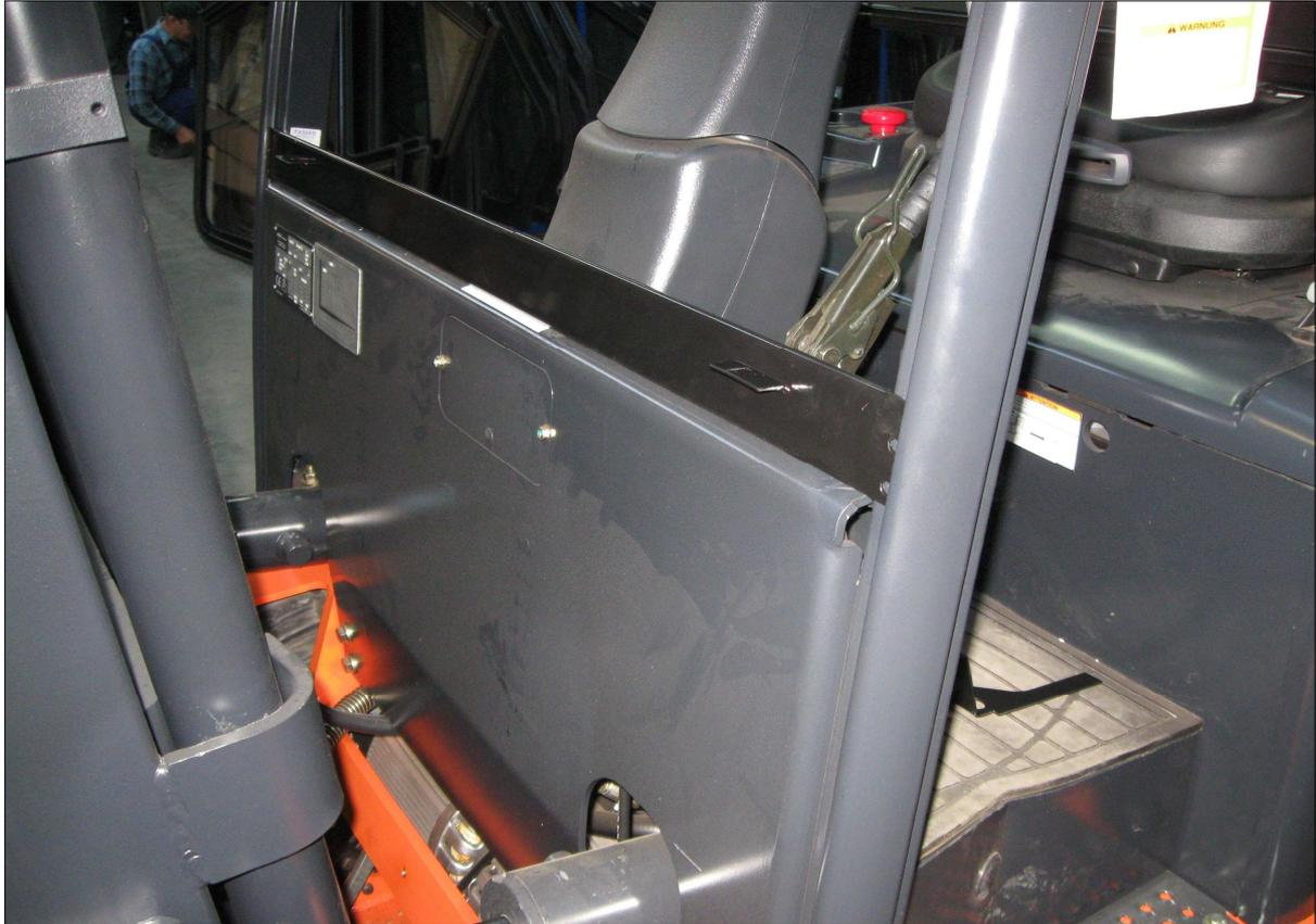
3. Ajuster **le vitre avant** avec les fixations sur le cadre du chariot et sur les tôles déjà montées en le pressant légèrement sur le joint d'étanchéité. Marquer le point pour les trous sur le cadre du chariot en utilisant les fixations du vitre. Forer les trous en utilisant le foret Ø 11 et y mettre les rivets à jaquette M8. Visser le vitre à l'aide des vis M8x25.
