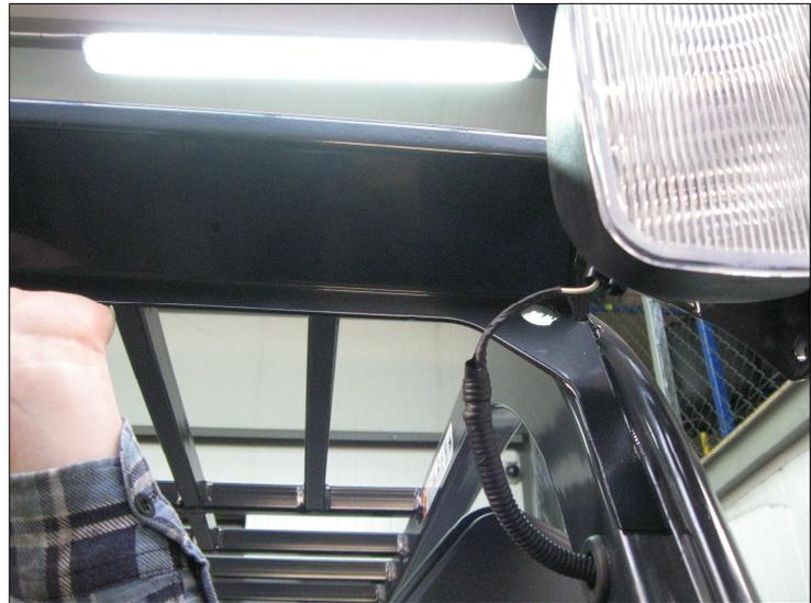
2. *Ajuster la **tôle avant inférieure** à la cavité du cadre du chariot de cette façon pour que la tôle inférieure s'appuie par son bord inférieur sur le pupitre du chariot. Visser la tôle sur le cadre du chariot à l'aide des clous de Parker 6,3x25 à travers les trous sur les extrémités de la tôle.*
