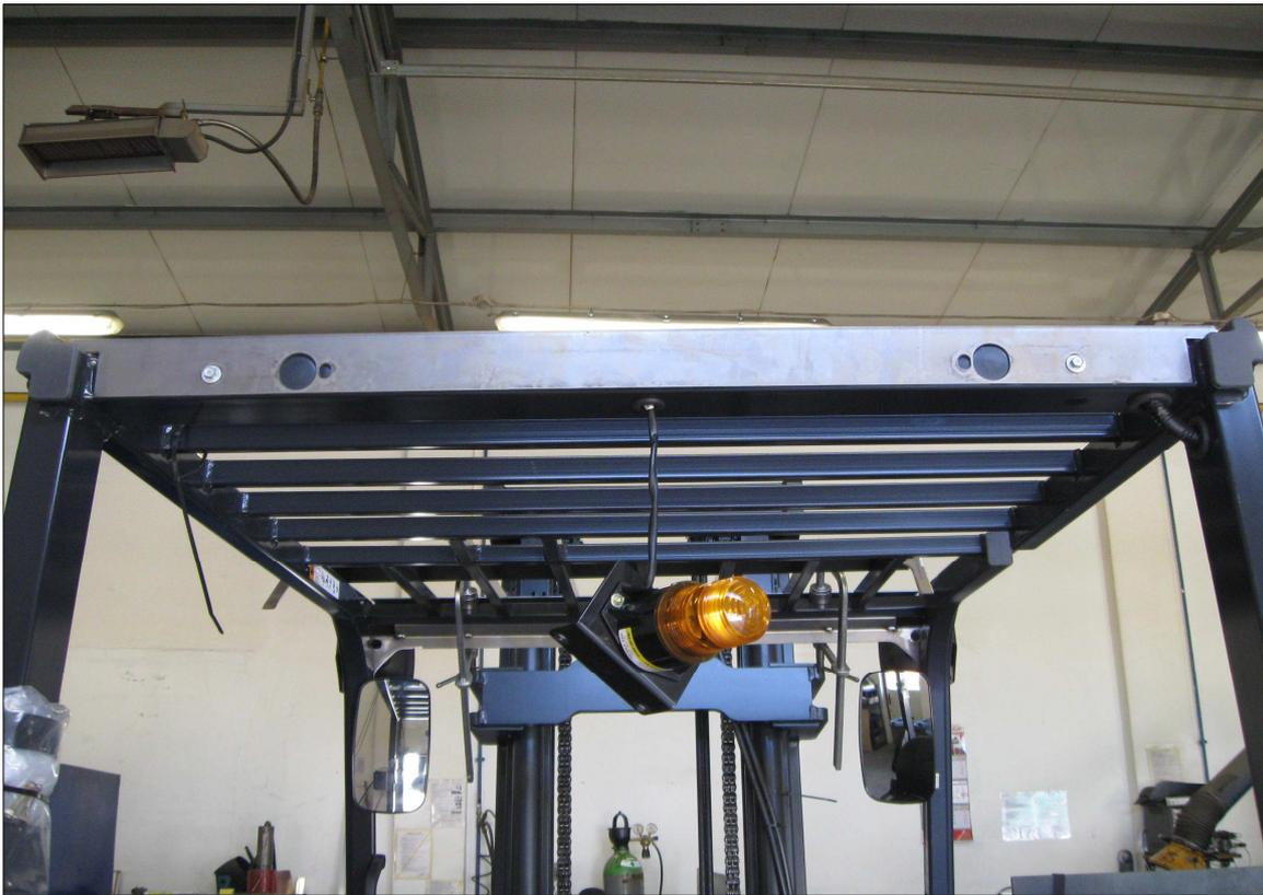
2. *Ajuster **la tôle arrière supérieure** sur la surface arrière du cadre et la presser sur le joint d'étanchéité au profilé arrière du cadre. Visser la tôle à travers les trous sur les extrémités de la poutre à l'aide des clous de Parker 6,3x25.*
