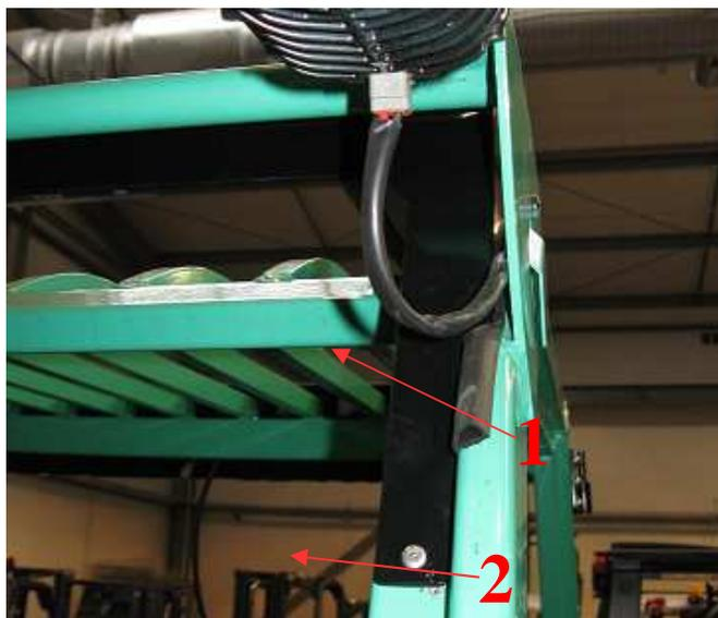
4. Marquer les points pour les trous de montage sur la partie avant du toit sur le cadre du chariot et forer les trous  $\text{Ø}7$ . Riveter la tôle du toit sur le cadre du chariot à l'aide du rivet démontable (2)
