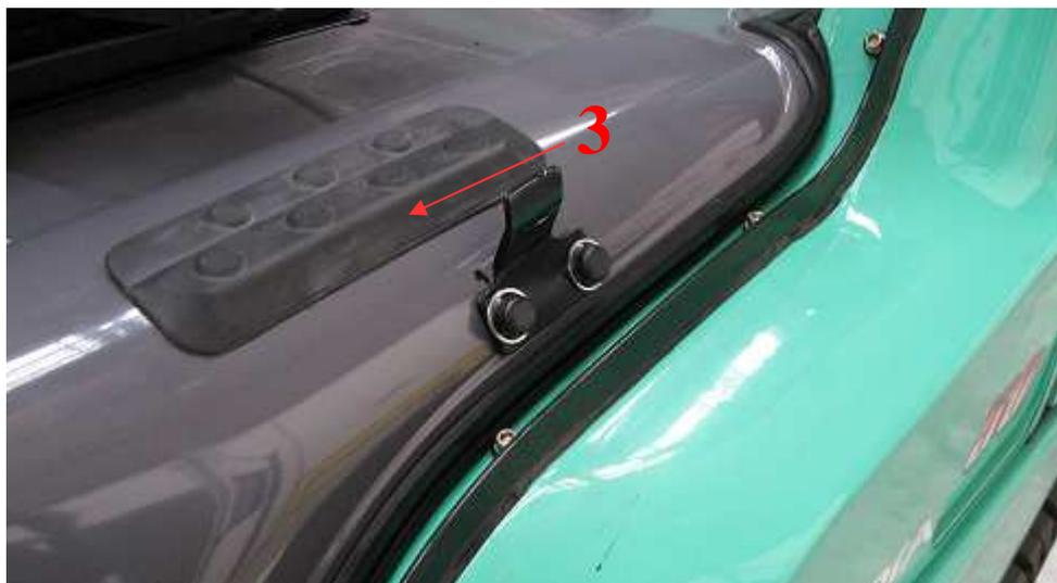
7. Quand la porte est fermée marquer sur la partie antérieure du cadre du chariot le point du montage de la fixation (4). Sur les points marqués forer les trous  $\varnothing 11$  y mettre les rivets à jaquette M8. Visser la fixation de l'axe d'articulation au cadre à l'aide des vis M8x25.
