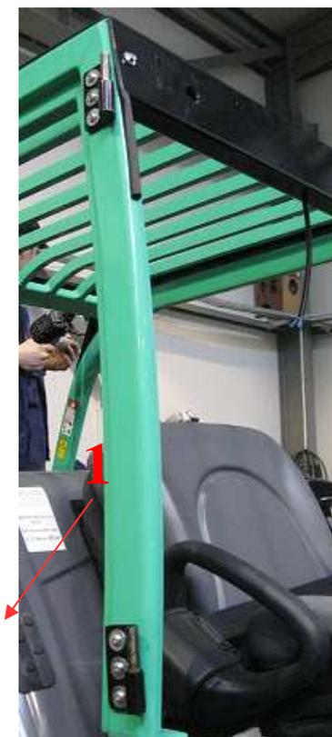
5. Quand la porte est fermée, marquer sur le profilé supérieur du cadre du chariot les points pour les trous de montage en utilisant la tôle de protection de l'accroche de la porte (2). Forer les trous  $\varnothing 9$  et y mettre les rivets à jaquette M6. Visser la tôle de protection au cadre à l'aide des vis M6x20.
