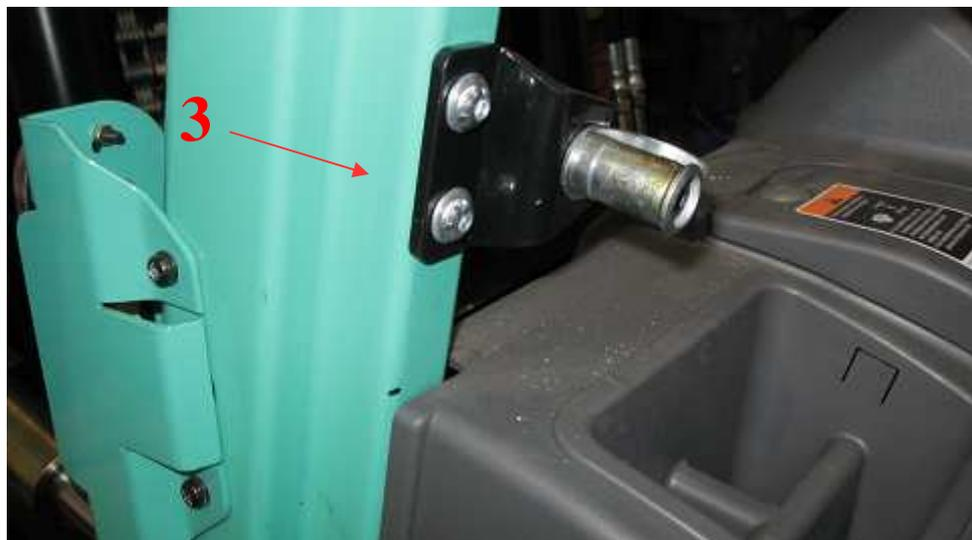
10. Apposer les méplats de la porte (4) sur la tôle latérale du chariot de cette façon pour qu'après avoir fermé la porte le joint d'étanchéité du bord de la porte adhère également au méplat(4). Marquer les points pour les trous de montage en utilisant le méplat sur la tôle latérale du chariot. Forer les trous  $\varnothing 9$  et y mettre les rivets à jaquette M6. Visser le méplat à la tôle latérale du chariot à l'aide des vis M6x20.
