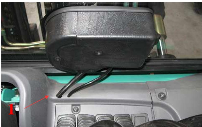
3. Visser la poignée du réservoir de lave-glace (2) à gauche de la chambre du moteur sur le lieu du trou original à l'aide de la vis M8x16. Brancher le tuyau et le faisceau au réservoir de l'arroseuse.
