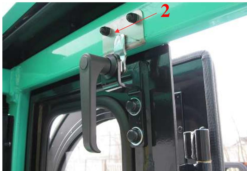
6. Quand la porte est fermée, marquer sur le capot du moteur les points pour les trous de montage en utilisant l'accroche de la porte partagée (3). Forer les trous  $\varnothing 11$  et y mettre les rivets à jaquette M8. Visser l'accroche sur le capot du cadre à l'aide des vis M8x20.
