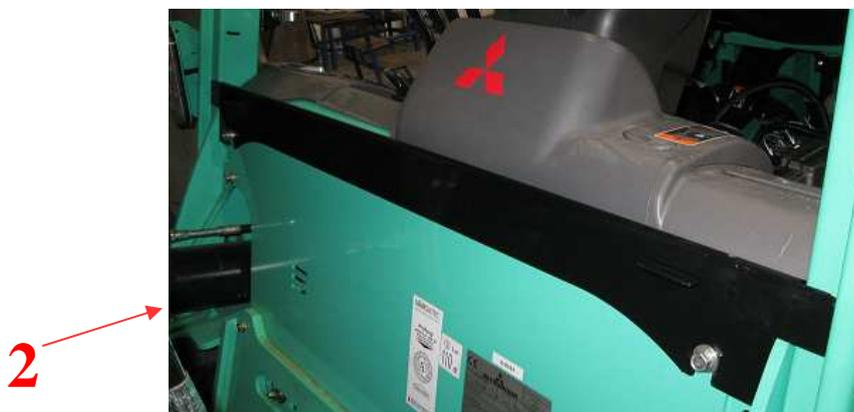
3. Apposer le vitre avec les poignées de fixation aux profilés avant du cadre du chariot de cette façon pour que le vitre empiète également la partie avant du toit et la tôle inférieure. Marquer sur le cadre du chariot les points des trous de montage en utilisant les poignées de fixation (3).
