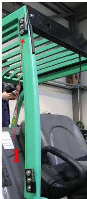
5. Monter le compas à gaz à l'axe sur le cadre de la porte. Sur l'autre bout du ressort mettre une fixation (2).
