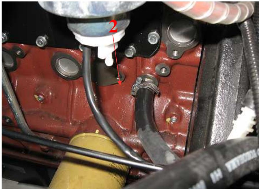
6. Du côté supérieur arrière du moteur dévisser la tubulure et visser la réduction (3). Monter à la réduction le tuyau sortant la substance de chauffage.
