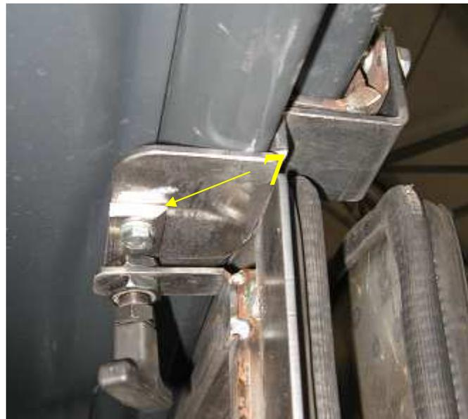
5. Serrer la porte sur le cadre, mettre le collier avec la prise du verrou ( 8 ) sur le profilé avant du cadre du chariot et visser à l'aide de la vis M8x50. Le collier avec la prise du verrou devrait être vissé à une telle hauteur pour qu'il permette ouvrir librement la porte.
