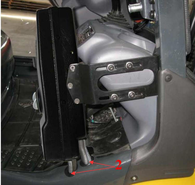
3. Fixer le chauffage sur son ancrage. Approcher les durites vers le compartiment moteur.
