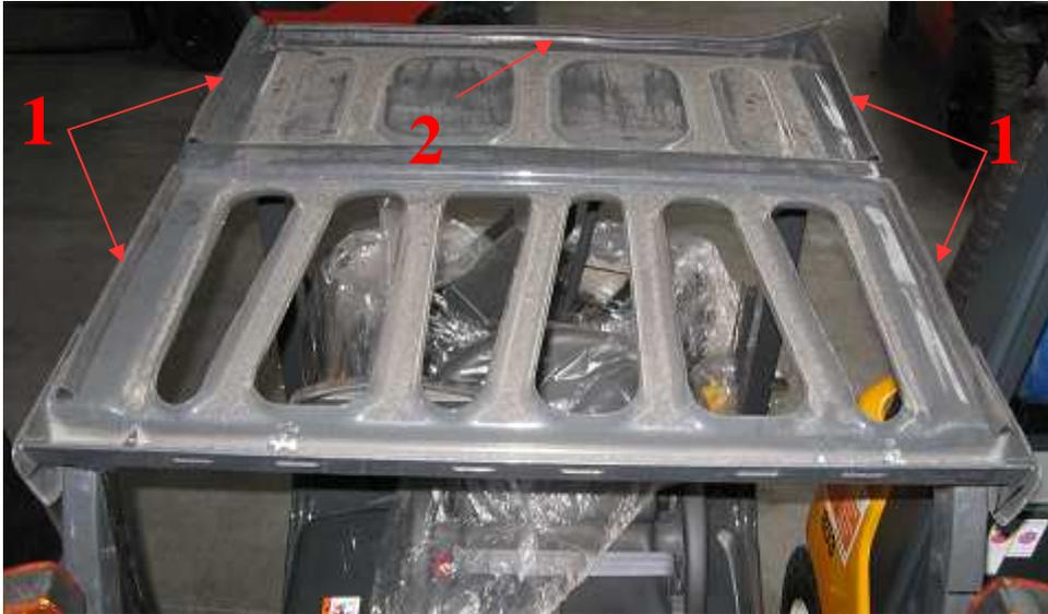
2. Positionner le toit sur la face supérieure de l'OHG, veillez à équilibrer l'adhérence. Fixer la partie arrière puis centrale du toit avec des vis auto-perforantes  $\text{Ø}6$ , 3x32 (3). Fixer la partie avant du toit (4) sur la barre frontale du panneau avant avec des vis auto-perforantes  $\text{Ø}4$ , 8x19.
