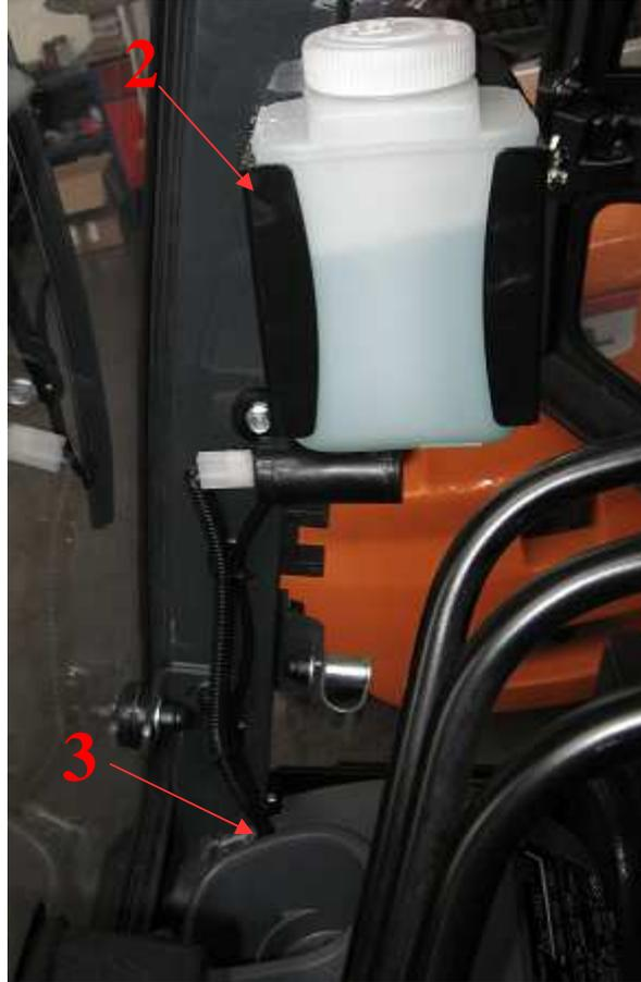
4. Percer Ø22 (3) sur la partie avant droite du cockpit. Approcher les câbles électriques et le tuyau du réservoir de lave glace arrière depuis le dessous du cockpit vers le montant avant droit du profil. Brancher le tuyau et les câbles d'alimentation sur le réservoir de lave glace.
