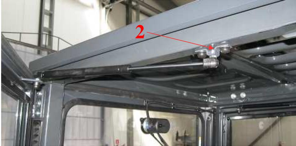
7. Fermer la porte, marquer les positions de perçage pour le crochet de fermeture (3) sur l'OHG. Percer  $\varnothing 11$ , puis insérer des écrous rivet M8. Fixer la fermeture avec des vis M8x25. Marquer la position du guide glissière (4), percer  $\varnothing 9$  puis insérer des écrous rivet M6. Fixer le guide sur l'OHG avec des vis M6x20 à tête plate.
