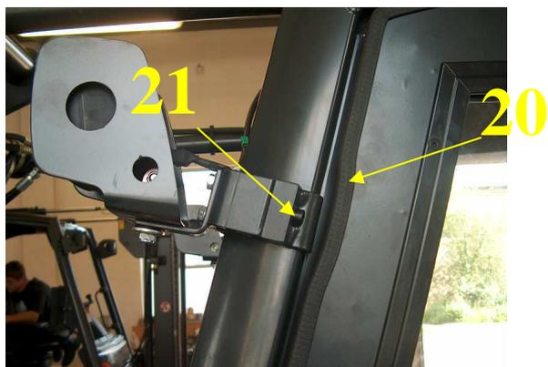
2. Posez la fixation de la lampe halogène contre le trou original du cadre du chariot et repéré le trou pour les vis M8x15. Percez un trou au Ø9 à l'endroit repéré.
