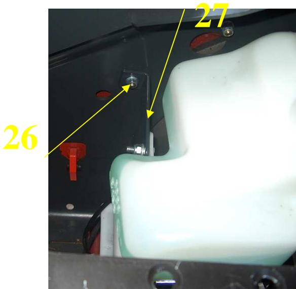
3. Connectez le bidon de lave-glace avant avec le gicleur en utilisant un tuyau.
