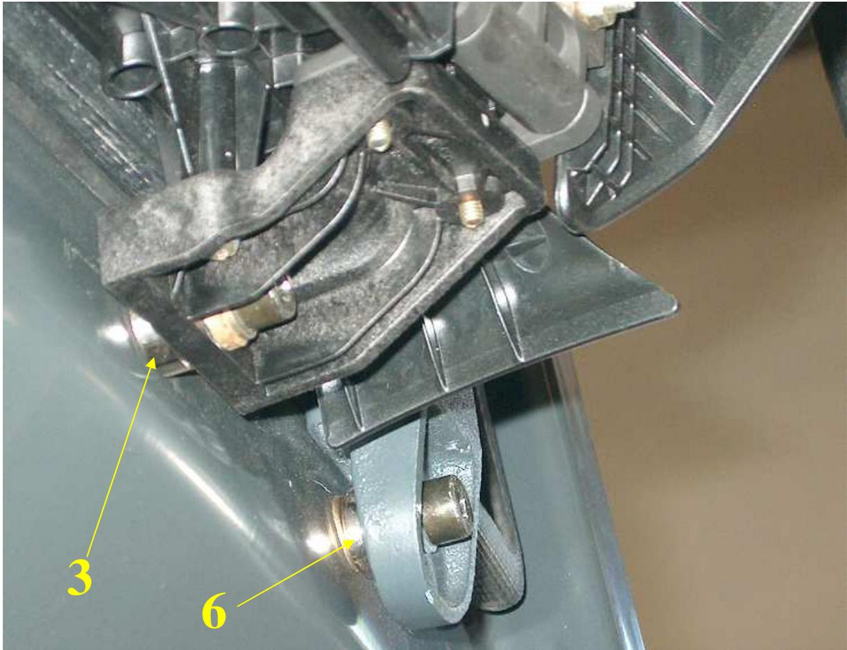
2. Positionnez les écrous rivets M8 dans les ouvertures du cadre du chariot, serrez légèrement les supports (4) qui tiennent la vitre arrière, à l'aide des vis M8x35 (5) et des 18/ Ø 9 entretoises (6).
