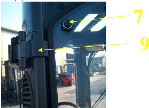
4. Resserrez les supports qui tiennent la vitre arrière, avec les vis M8x35 (5).
