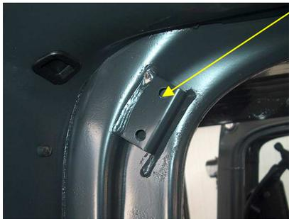
4. Attachez le support de compas (12) à l'aide des vis M8x25 (13) et des entretoises au  $\text{Ø}18 \times \text{Ø} 8$  (14).
