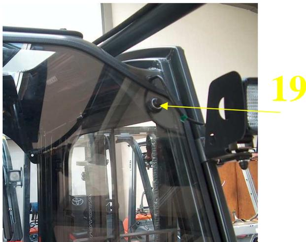
4. Resserrer les supports de fixation qui tiennent la vitre avant avec les vis M8x35 (18).
