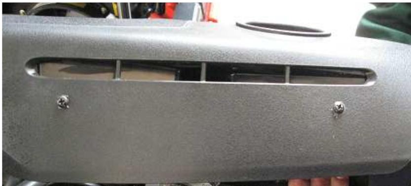
7. Fixer la résistance (6) à la partie inférieure du tableau de bord de coupe droit (2) en utilisant Ø 4,8 x19 vis auto-perceuses.
