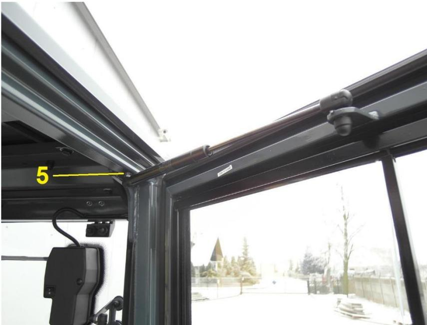
13. Fixer le vérin à gaz sur la porte avec un écrou M8
