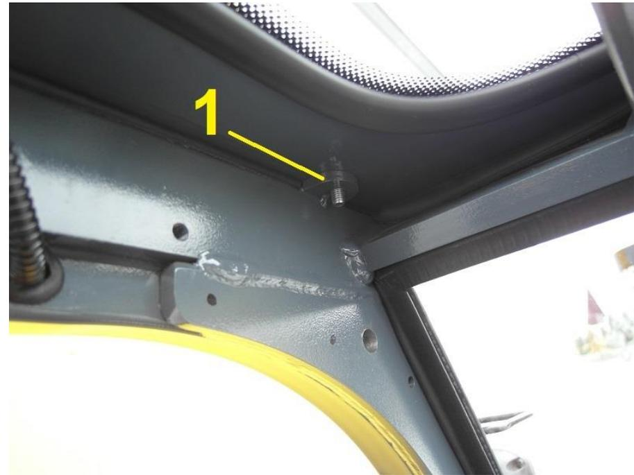
3. Poser le toit sur le protège conducteur, puis fixer le en partie avant sur les 2 supports d'origine (1) à l'aide de vis HM8x25 et des rondelles étanches
