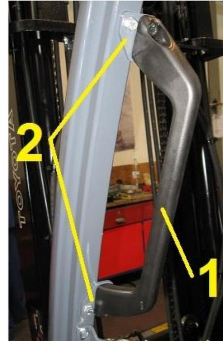
4. Présenter la porte contre le protège conducteur en prenant soin de la positionner afin d'avoir un jeu régulier en pourtour de la porte et que le joint soit en contact avec la surface plane du tube du protège conducteur
