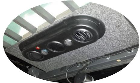
Pavillon de toit intérieur avec diffuseurs d'air et commandes
