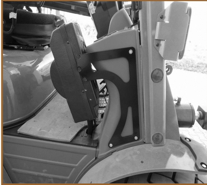
6. Raccorder les durites au chauffage et bloquer leur position avec le collier de serrage
