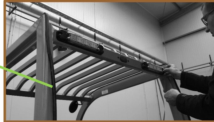
3. Positionner la traverse avant haute (2) sur le protège conducteur.
