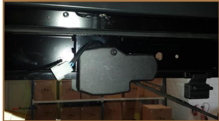
5. Monter le moteur d'essuie-glace sur le cadre métallique
