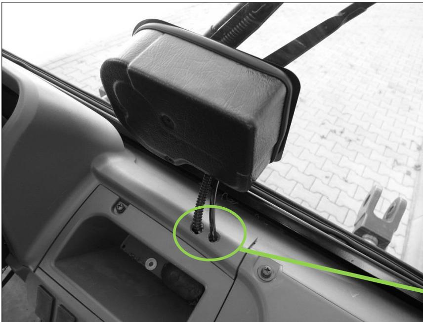
5. Démontez la partie du tableau de bord se trouvant sous la platine d'interrupteur
