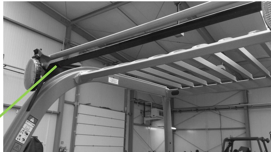
4. Poser le toit sur le protège conducteur et mettre l'arrière en butée contre le protège conducteur. Vérifier que les trous de la traverse avant tombent en face des écrous sertis
