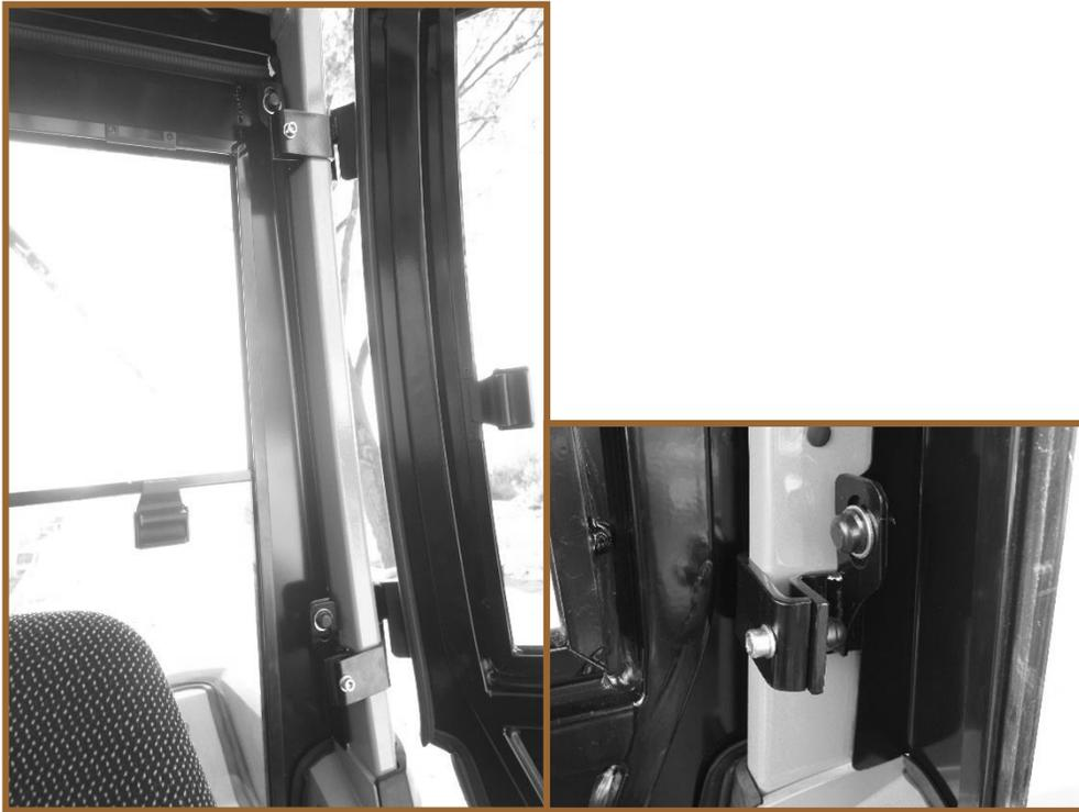
5. . Fixer le panneau arrière sur les 4 équerres (1) ou (2) à l'aide de vis TH M8X20 et de rondelles plates (Jouer sur les lumières de différentes pièces pour ajuster la position)
