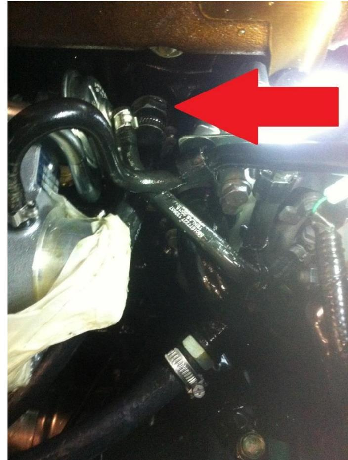
3. Sur le moteur repérer et dévisser le bouchon d'origine. Puis viser le raccord M18x1.5 fourni
