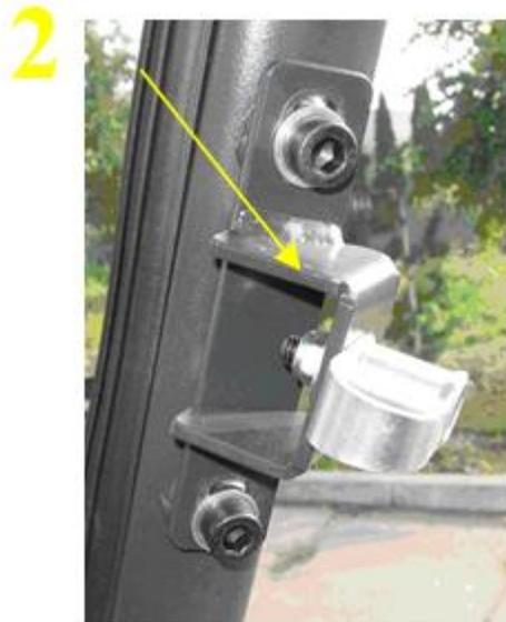
2. Visser la fixation ( 2 ) du verrou sur le cadre du chariot à la place des trous originaux à l'aide des vis M10x25.
