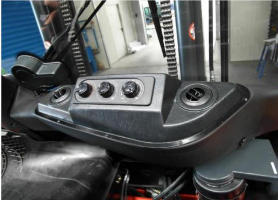
15. Fixer le panneau de commande du chauffage sur le tableau de bord avec des vis Ø3,9x16
