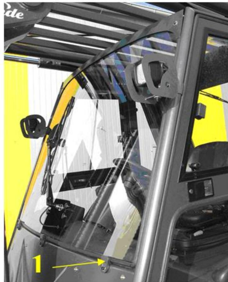
3. Appuyer la vitre avant sur les poignées de fixation et ensuite visser la partie supérieure du vitre avec la tôle ( 2 ) avant supérieure à l'aide des vis M8x45.
