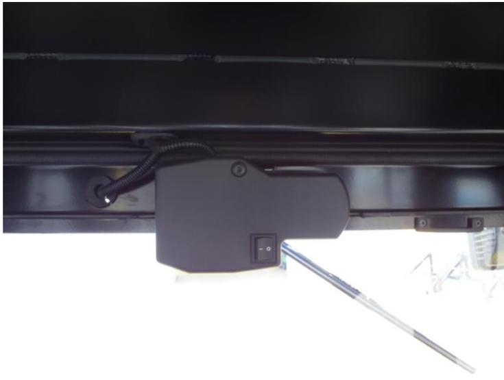
8. Fixer le moteur d'essuie-glace sur le cadre arrière puis monter le bras et le balai en prenant soin de régler leur position
