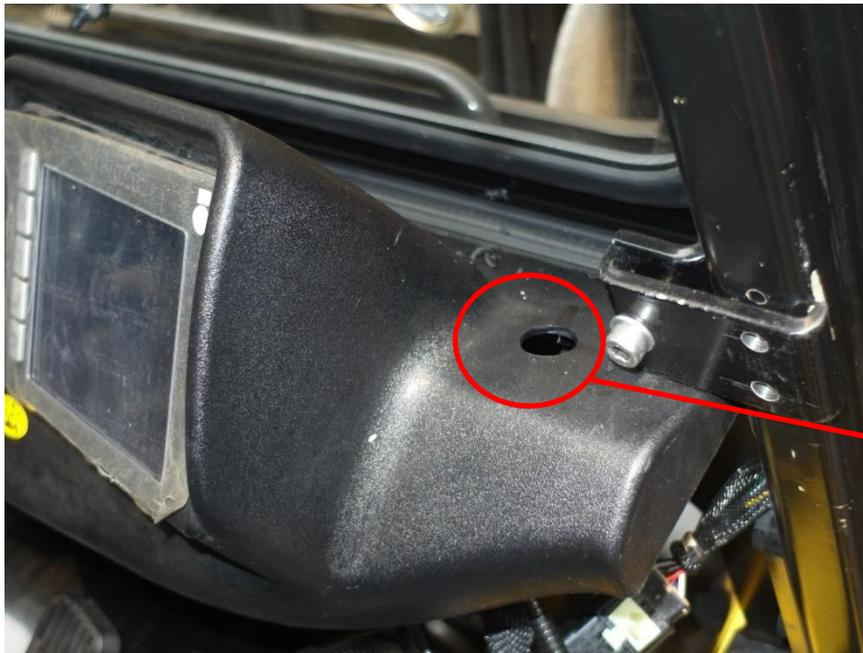
5. Côté droit, sur le haut du tableau de bord faire un trou Ø20 (2) pour le passage du faisceau et du tuyau de lave-glace
