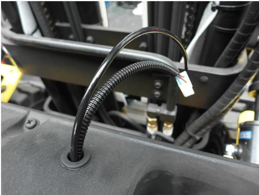
7. Repérer sur le faisceau partie avant fourni le connecteur du moteur d'essuie-glace. Faire passer ce connecteur par le trou (3) avec le tuyau de lave-glace et rajouter un passe fil pour protéger
