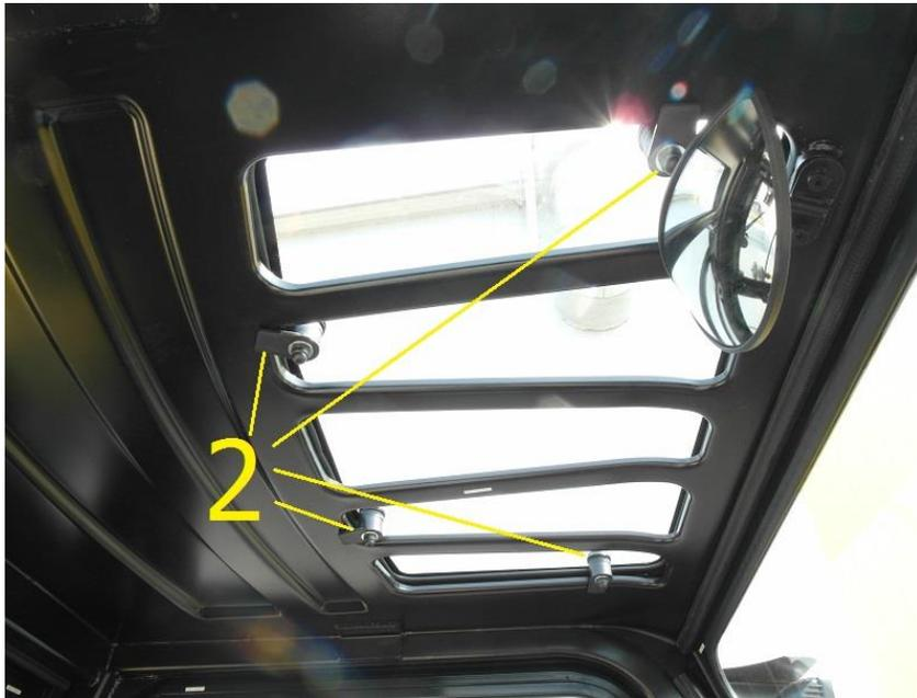
2. Tourner les 4 pattes (2) sous le toit du protège conducteur, puis serrer.
