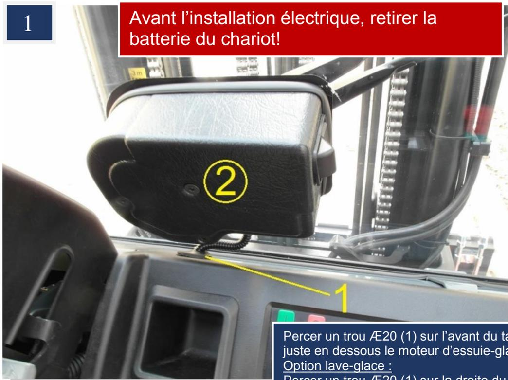
Percer un trou  $\varnothing 20$  (1) sur l'avant du tableau de bord juste en dessous le moteur d'essuie-glace (2)
