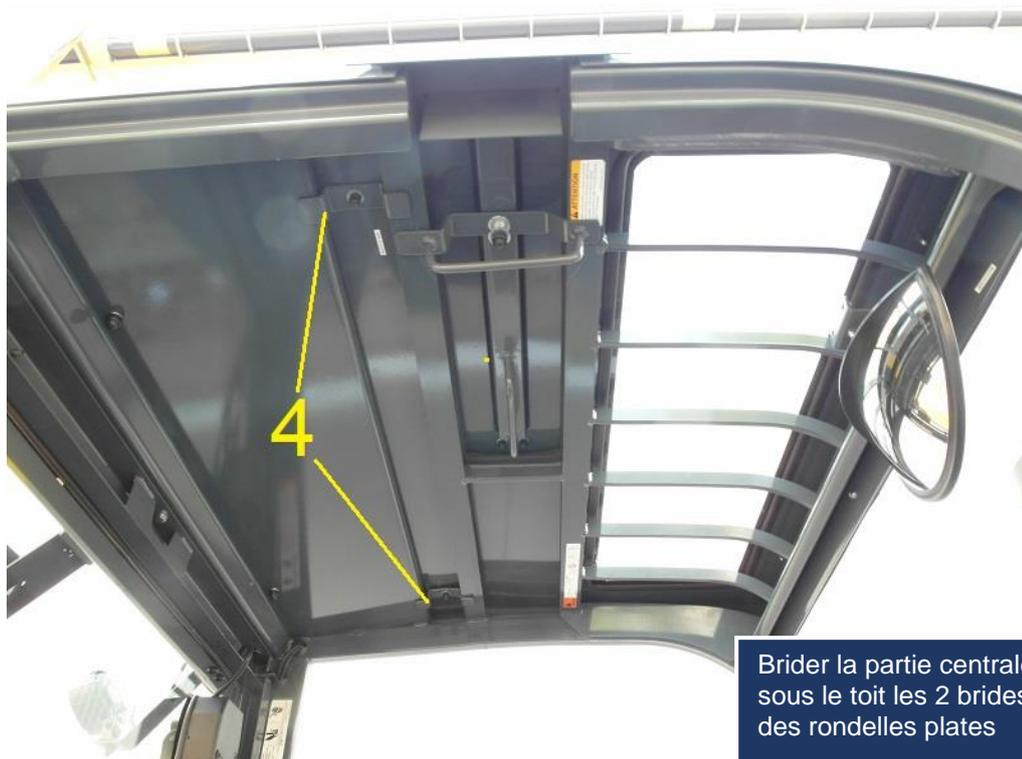
Briquer la partie centrale du toit en vissant sous le toit les 2 brides (4) avec des vis M6x20 et des rondelles plates
