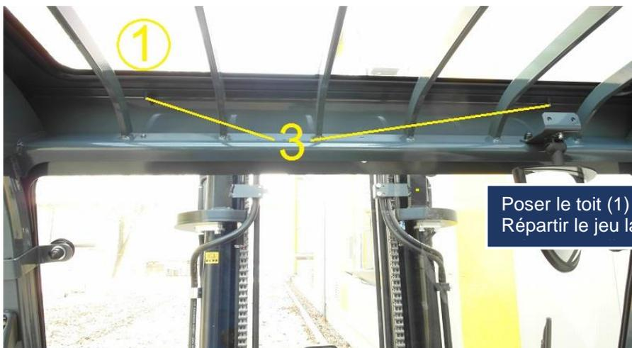
Poser le toit (1) sur le toit du protège conducteur.
