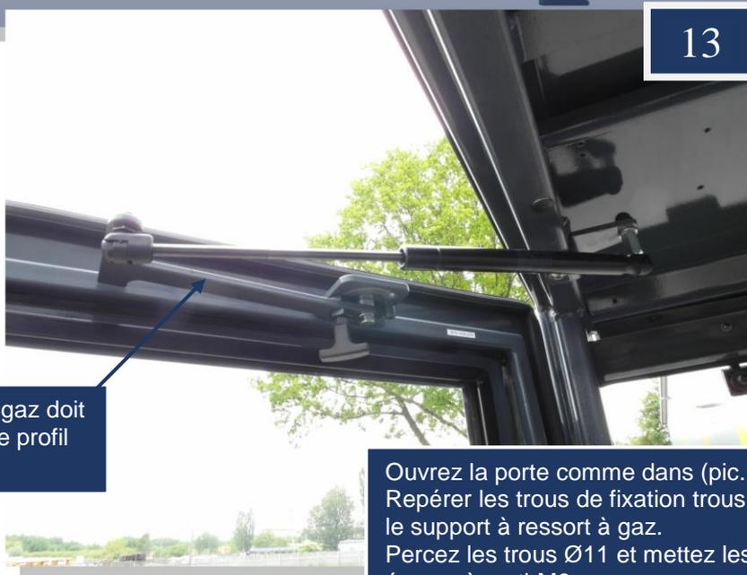
Le support du vérin à gaz doit être en contact avec le profil de la porte
