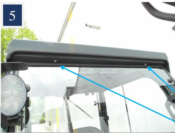
Présenter et fixer la tôle avant haute sur la tôle avant haute du protège conducteur avec des vis M8x25
