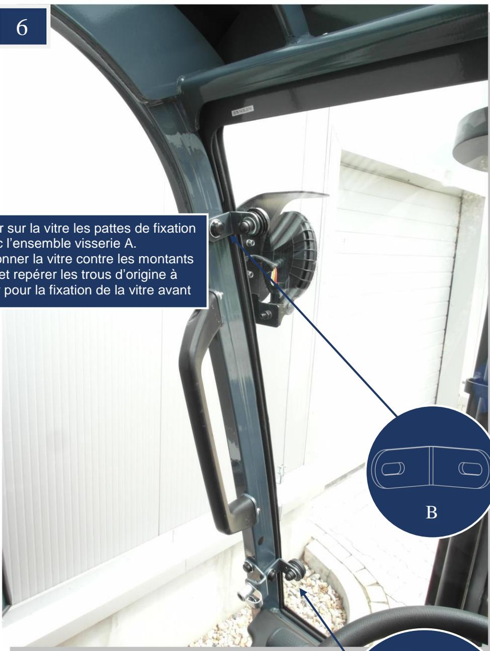
Placer dans les trous repérés des écrous à sertir M8.
