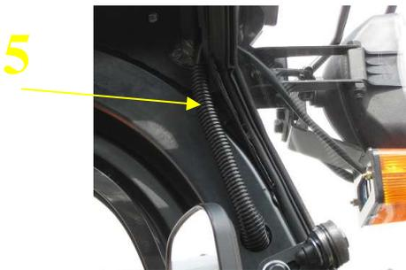
5. Faire passer le faisceau essuie-glace ( 6 ) par le profilé postérieur du cadre du toit du chariot ( 7 ) et par le profilé postérieur droit ( 8 ) du cadre du chariot aux trous originaux se trouvant sur les profilés. Faire passer le faisceau ( 6 ) dans la direction de la boîte de coupe-circuit originale.
