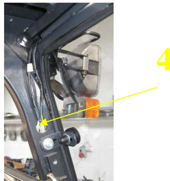
4. Monter le tuyau masquant ( 5 ) sur les faisceaux des lampes antérieures.
