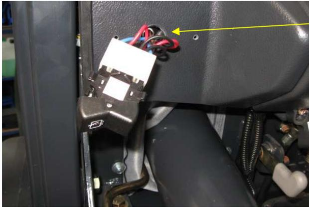
12. Visser le boîtier de l'interrupteur ( 13 ) sur le pupitre à l'aide des clous de Parker. Installer l'interrupteur essuie-glace.
