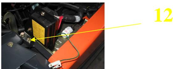
9. Faire passer le faisceau du chauffage sous la partie antérieure du plancher.
