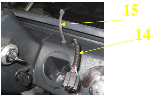
14. Visser le mécanisme moteur essuie-glace de la vitre antérieure et ensuite monter le balai et bras essuie-glace. Brancher le faisceau au mécanisme moteur essuie-glace et lave-glace
