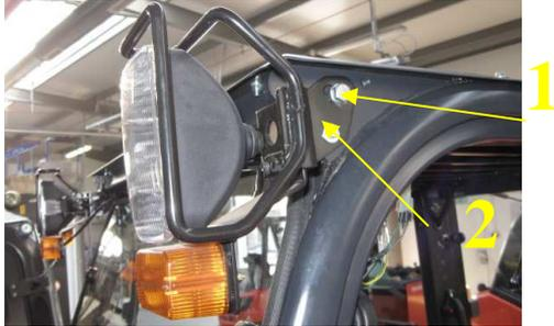
2. Forer un trou  $\varnothing 6,4$  sur le cadre du chariot sur la place du trou bas de la poignée de fixation. Fileter le trou foré à l'aide du taraud M8. Visser la poignée ( 1 ) au cadre du chariot à l'aide des vis M8x20 ( 2 )
