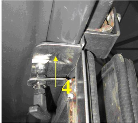
5. Serrer la porte sur le cadre, mettre le collier avec la prise du verrou ( 5 ) sur le profilé avant du cadre du chariot et visser à l'aide de la vis M8x45. Le collier avec la prise du verrou devrait être vissé à une telle hauteur pour qu'il permette d'ouvrir librement la porte.
