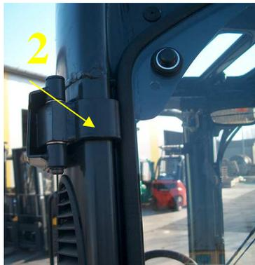
4. Mettre le collier ( 3 ) sur le profilé supérieur du cadre du chariot dans le lieu de la coupure de la partie supérieure de la porte. Visser le collier au cadre du chariot à l'aide des vis M8x30. Régler la poignée de la prise ( 4 ).
