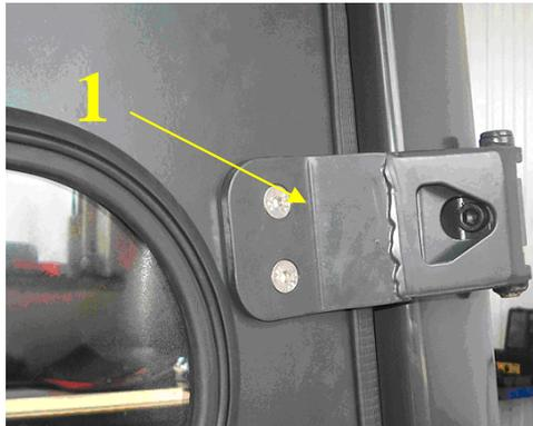
3. Mettre le collier ( 2 ) sur le profilé arrière du cadre du chariot et visser à la charnière ( 1 ) à l'aide des vis M10x25.
