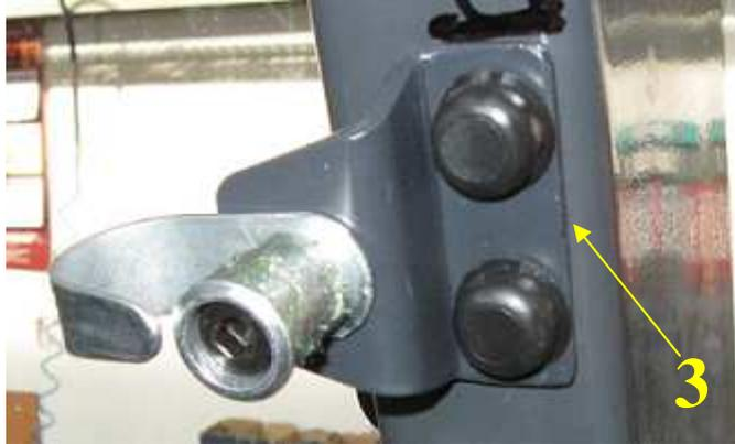
5. Monter le ressort de gaz au cadre de la porte. Sur l'autre bout du ressort mettre la fixation (4).
