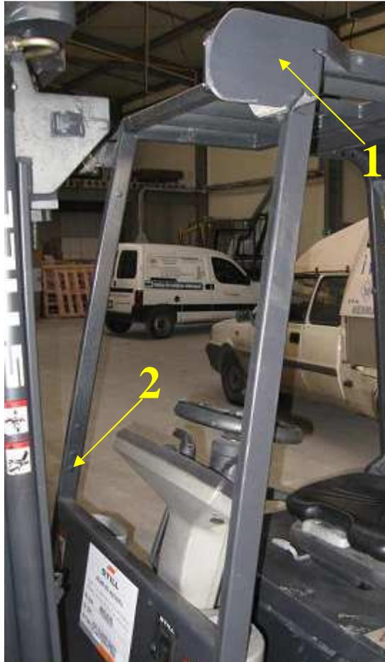
2. Mettre les écrous M10 dans les trous originaux (2) localisés dans la partie inférieure des montants bas du cadre du chariot.
