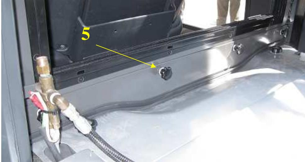
4. Dévisser la valve de gaz et visser à elle la poignée de fixation (6) à l'aide de la vis M8x20, et ensuite apposer sur la partie inférieure intérieure du profilé arrière du cadre du chariot. Marquer les points pour les trous de montage sur le cadre du chariot. Forer les trous Ø11 et y mettre les rivets à jaquette M8. Visser la poignée sur le cadre du chariot à l'aide des vis M8x20.
