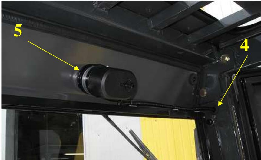
9. Coller la cale (5) sur le cadre arrière du chariot. Visser le mécanisme du porte-raclette arrière. Monter le bras et la raclette du porte-raclette. Raccorder le faisceau au mécanisme du porte-raclette.
