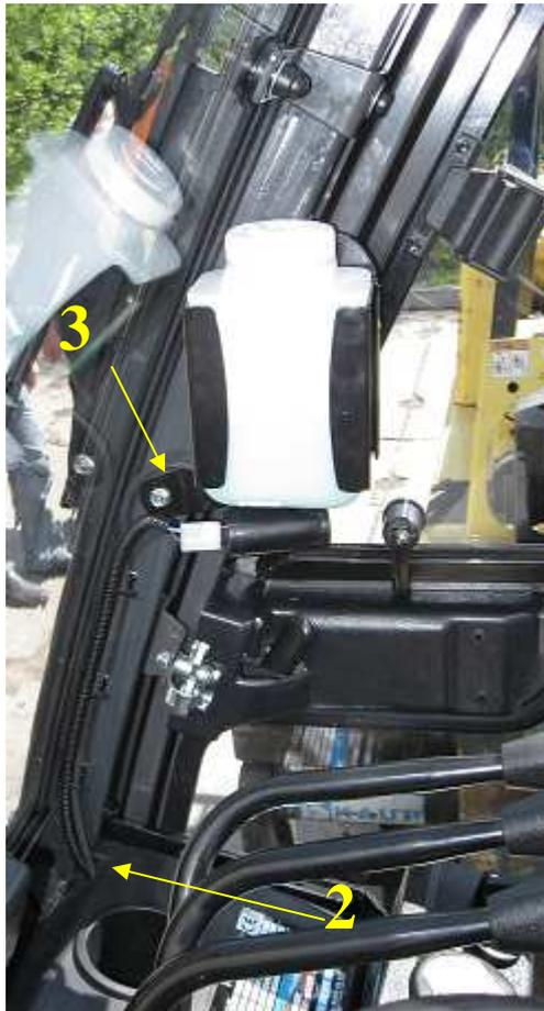
8. Dans la partie supérieure gauche du cadre du chariot (en regardant dans le sens de la circulation) forer le trou Ø13 (4).
