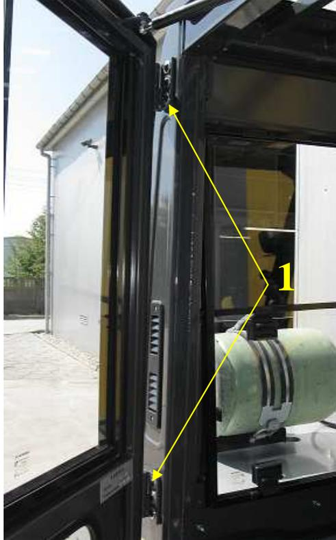
5. Monter le ressort de gaz à l'axe sphérique sur le cadre de la porte. Sur l'autre partie du ressort insérer le cube (2).
