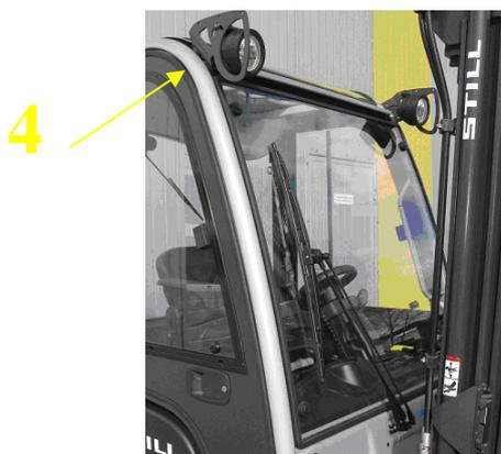
3. Marquer du toit les points pour les trous de montage sur le cadre du chariot. Forer les trous Ø7. Visser le toit sur le cadre du chariot à l'aide des vis M6x55 avec les cales entretoises
