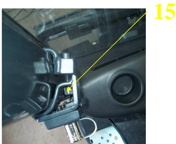
4. Ajuster et positionner la porte droite (9) sur le cadre du chariot de cette façon que la distance entre le bord de la porte (joint d'étanchéité) et le bord du cadre soit partout identique.
