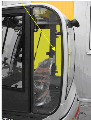
11. Monter les poignées de fixation (12) sur la partie arrière du cadre du chariot et visser la vitre (11) à l'aide des vis M8x40.
