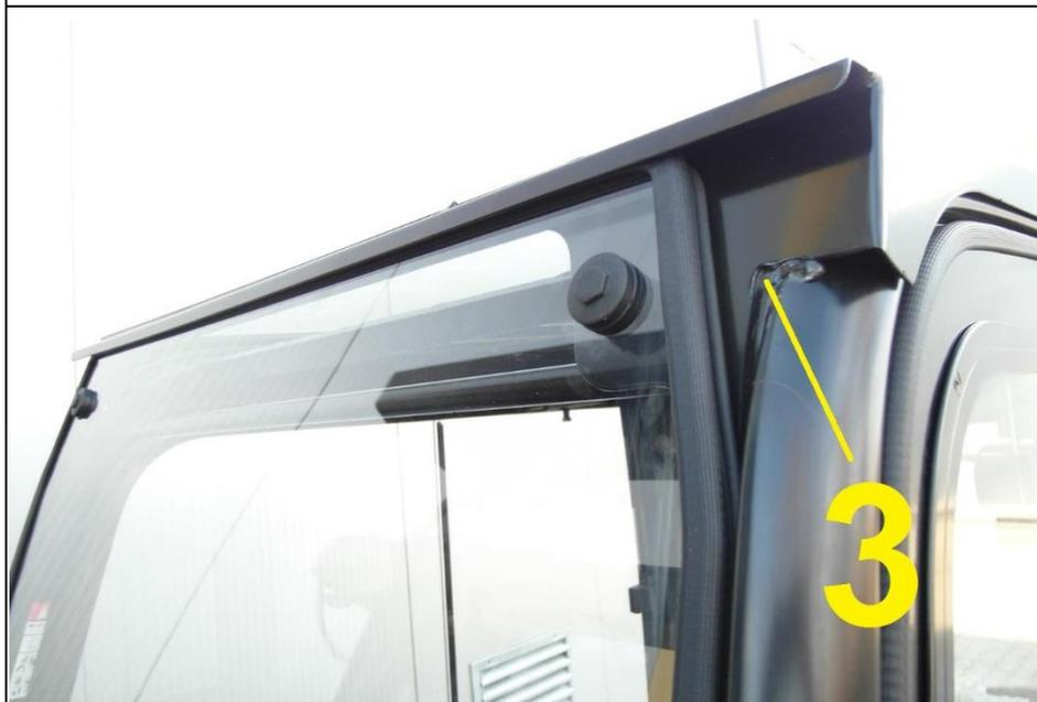
5. Parfaire l'étanchéité du toit en réalisant un masticage (3) entre la traverse avant haute et le protège conducteur
