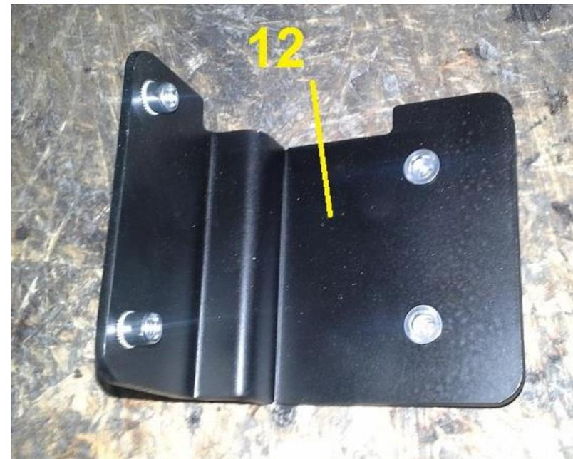
26. Fixer le chauffage (10) sur la tôle de plancher et en plaçant sous celle-ci la pièce (12)
