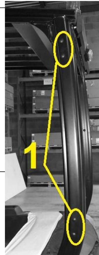
2. Placer des écrous à sertir M8 dans les trous hexagonaux prévus d'origine
