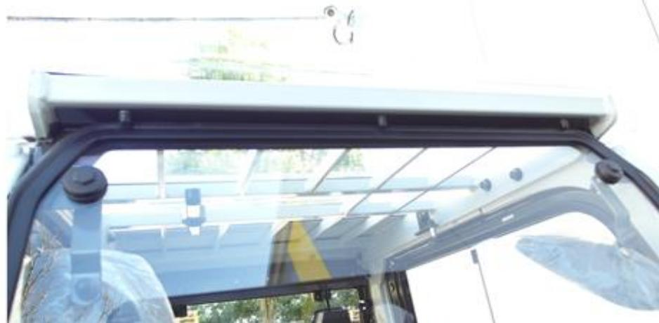
9. Assembler les miroirs intérieurs d'origines sur les supports fournis et fixer l'ensemble sur les vis de fixation de la vitre en partie haute.
