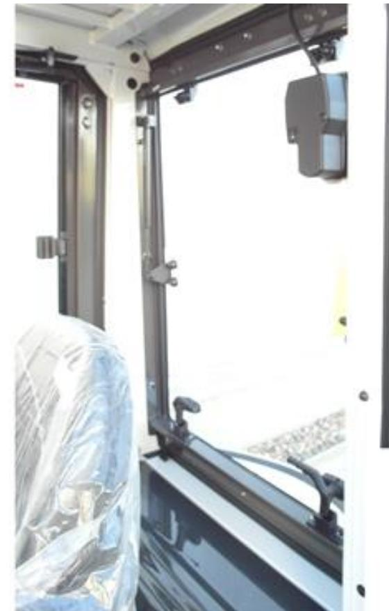
3. Fixer le panneau arrière avec des vis M8x20 (A) et des vis autoperceuses 6,3x25 (B)
