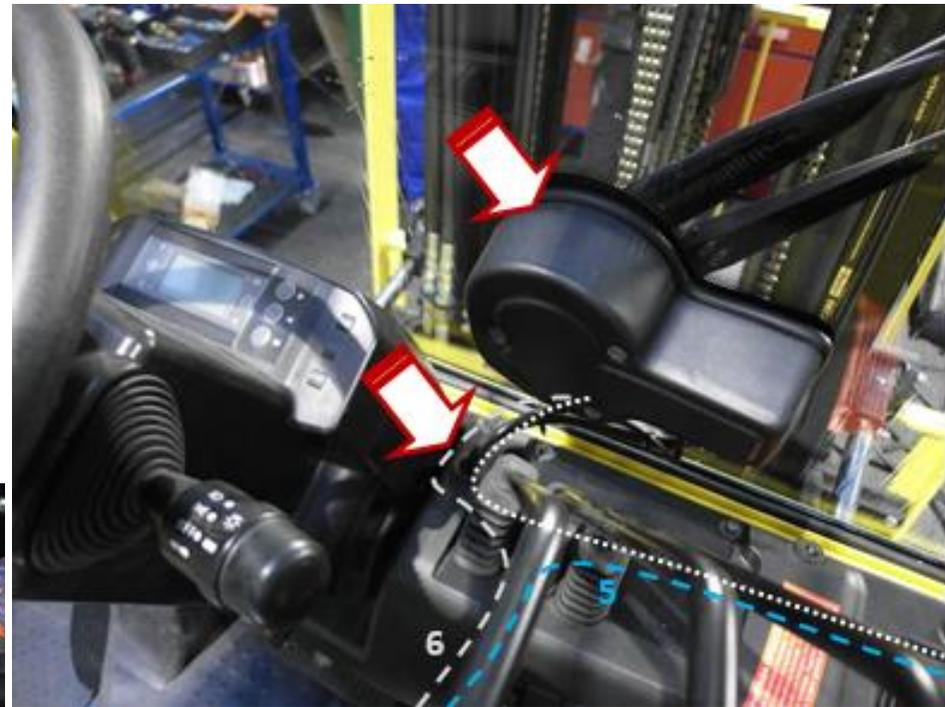
10. Tirer le faisceau d'essuie-glace arrière depuis le support fusible en le faisant passer pas le montant arrière gauche
