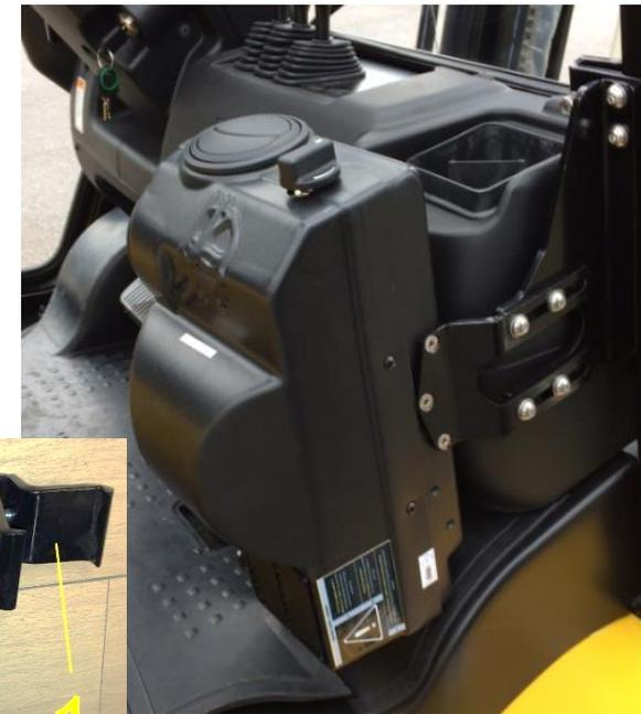
4. Retirer le tapis de sol et la tôle de plancher
