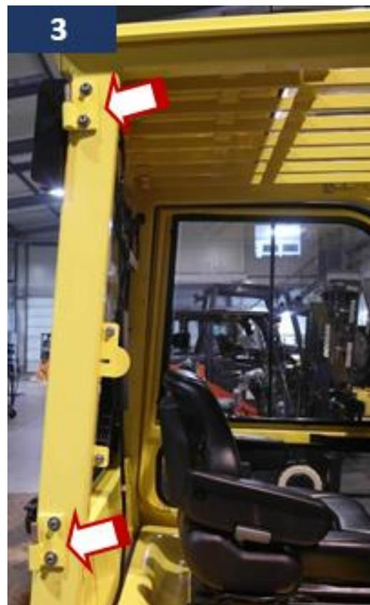
4. Présenter la porte et insérer les charnières femelles de celle-ci sur les charnières mâles montées précédemment Régler la position de la porte afin que son joint en pourtour soit en contact avec le protège conducteur et assure l'étanchéité, puis bloquer les vis des charnières.
