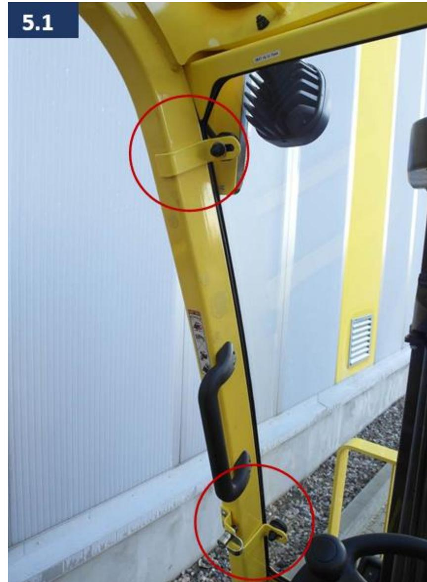
6. Remonter l'ensemble support et clignotant sur le chariot en utilisant la visserie d'origine 1 et 2
