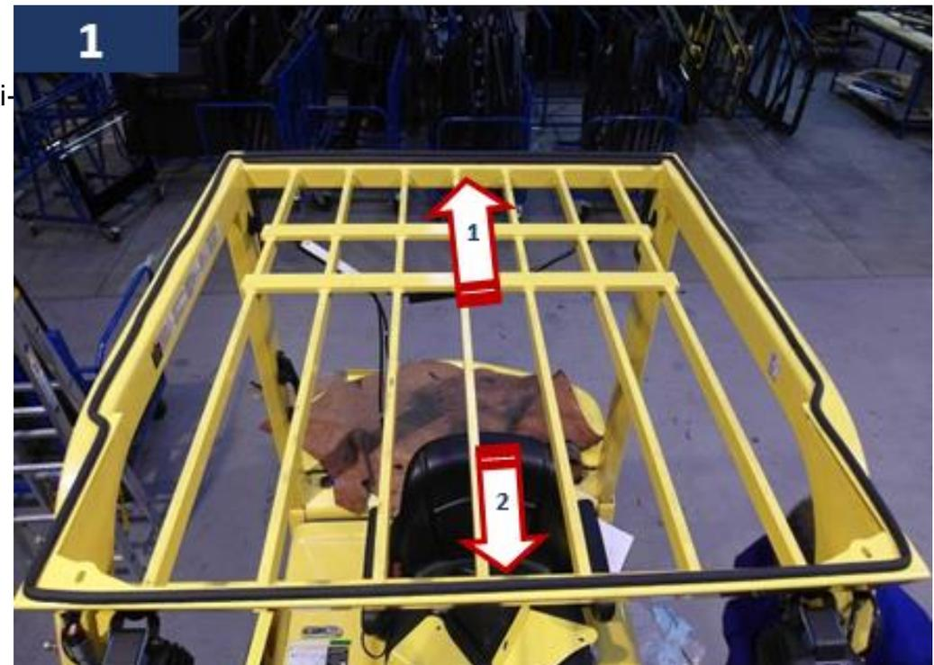
2. Positionner le toit sur le haut du protège conducteur.
