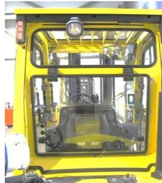
9. Réaliser un masticage entre les montants latéraux arrière du protège conducteur et les retours du cadre latéraux du cadre de métallique du panneau arrière afin d'étanchéifier l'ensemble
