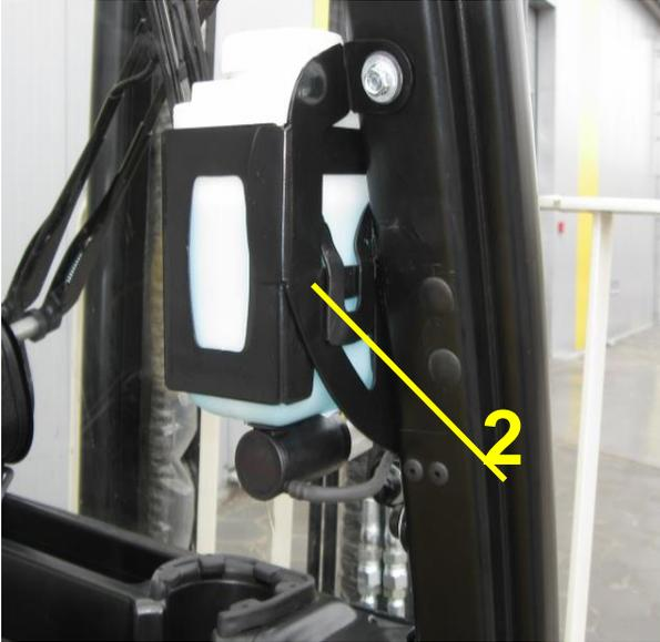
10. Fixer sur le montant avant droit du protège conducteur, le support bidon de lave-glace fourni (2) à l'aide de 2 vis auto perforantes 6,3x25
