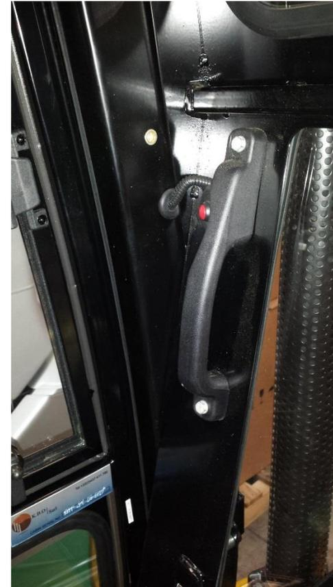
6. Mettre en appui sur l'intérieur des montants avant les butées (2) soudées sur le cadre métallique
