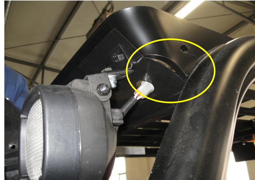
12. Réaliser un masticage entre la tôle avant du chariot et les montants latéraux du protège conducteur si le chariot n'est pas équipé d'un joint d'origine
