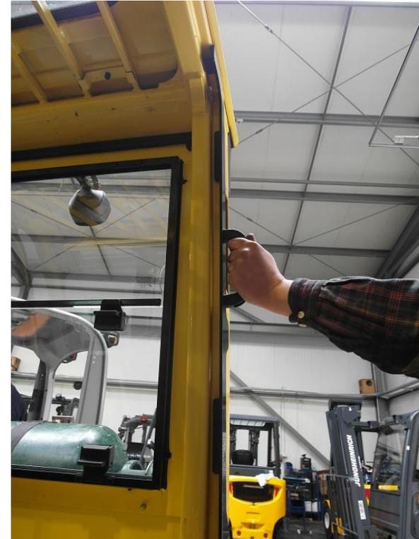
2. Une fois en bonne position, à l'aide d'un marteau, frapper contre le montant arrière du protège conducteur les 2 pointeaux en bas du gabarit
