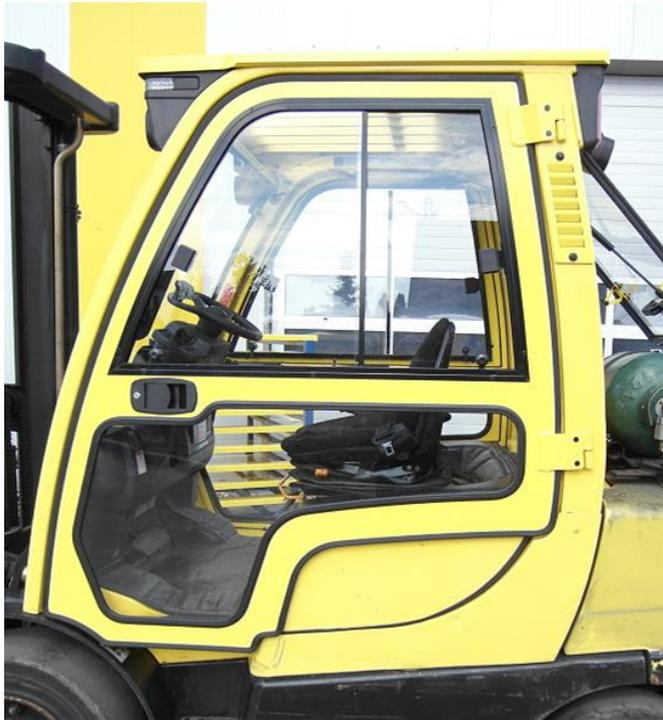
5. Monter la porte sur la charnière haute. Positionner la porte afin de répartir le jeu de manière uniforme par rapport au protège conducteur.
