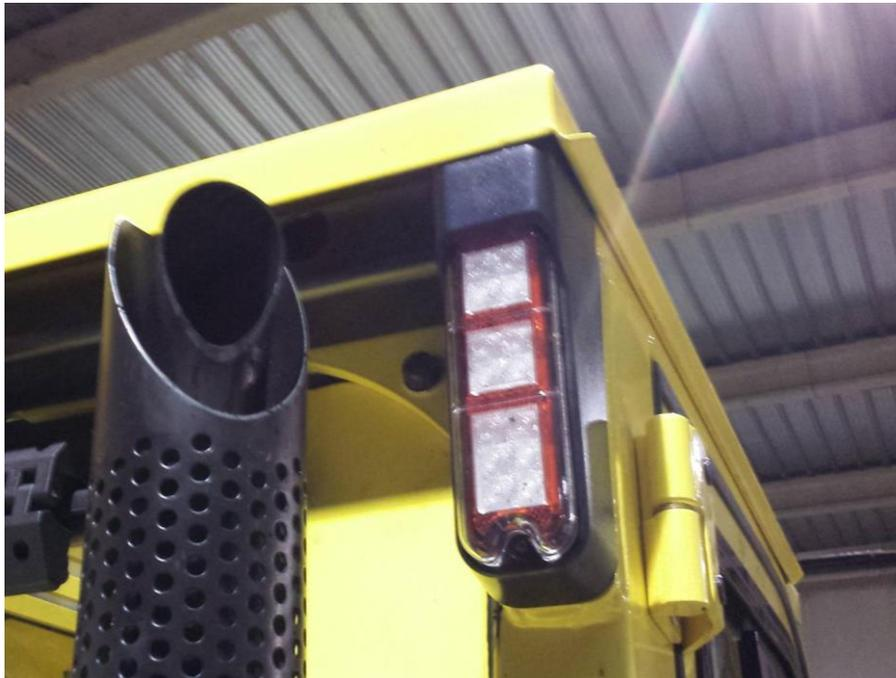
2. Poser le toit sur le haut du protège conducteur en répartissant le jeu latéralement et en mettant l'arrière du toit en buté contre les feux arrière
