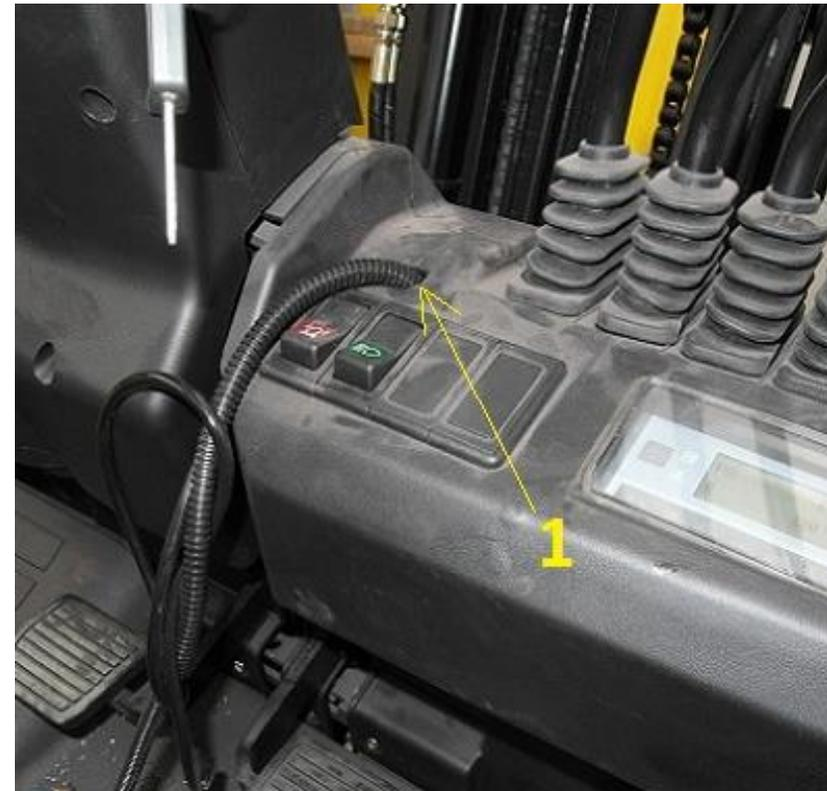
3. Percer un trou Ø20 (2) sur le tableau de bord à côté du montant avant droit du protège conducteur
