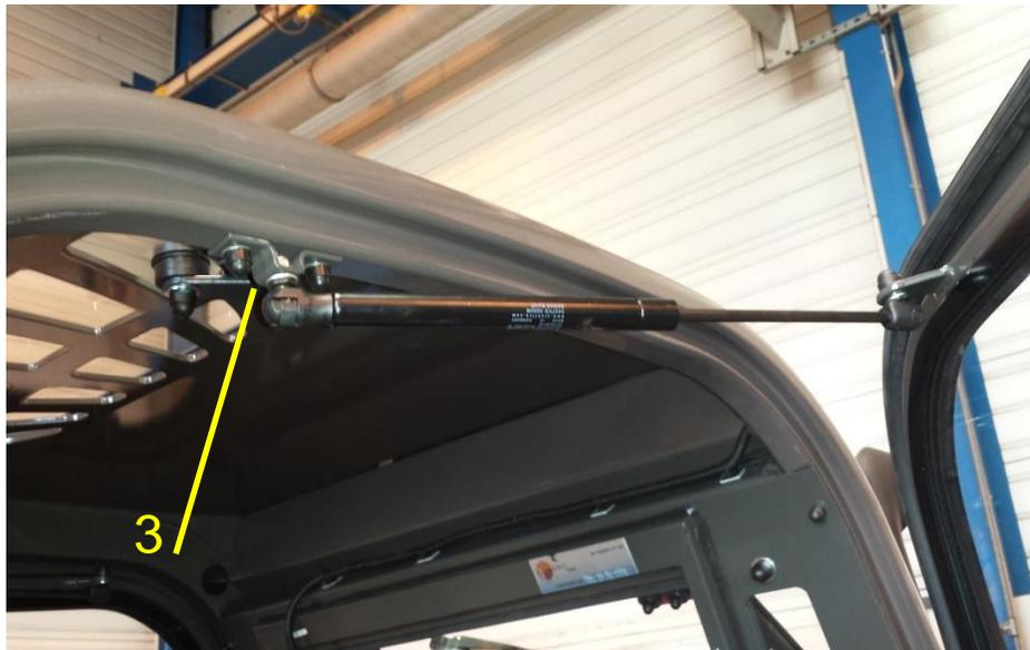
10. Fixer le vérin à gaz sur la porte et monter à l'autre extrémité le support vérin (3) avec un écrou M8
