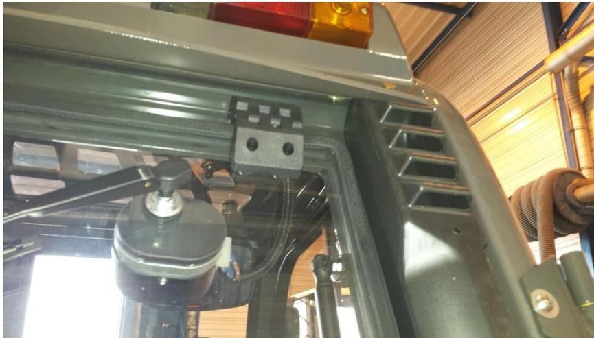
7. Coller sur la vitre à l'aide du silicone fourni la cale plastique noir fourni avec le moteur d'essuie-glace arrière
