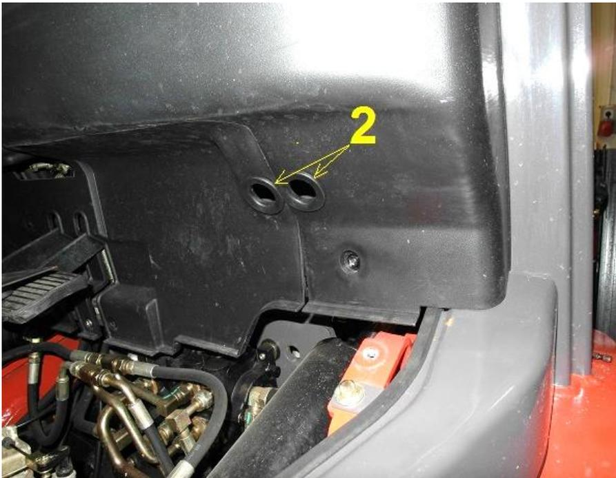
5. Repérer sur le bas du tableau de bord le centre des 2 tuyaux sortant du bloc chauffage
