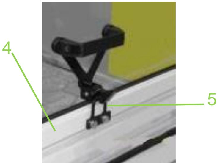
9. Fermer la vitre et positionner la gâche (5) de poignée arrière sur la traverse basse (4)
