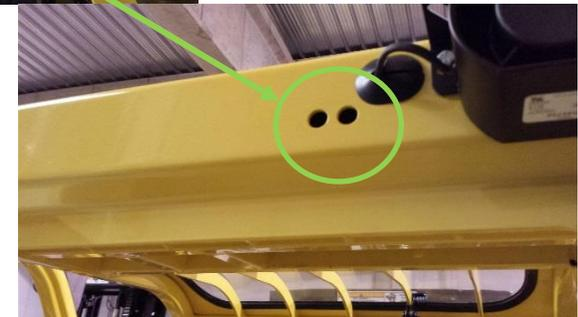
2. Présenter la vitre avec les charnières (1) montées contre l'arrière du protège conducteur. Fixer les charnières avec 4 vis HM10X25 et des rondelles plates
