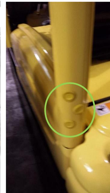
2. Repérer les charnières à l'aide de leur étiquettes et fixer les sur le protège conducteur à l'aide de vis M10x25 et des rondelles plates
