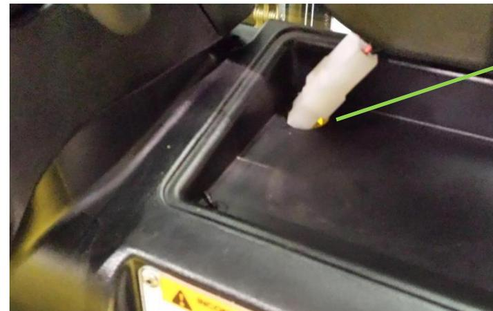
12. Faire un trou Ø20 dans la tôle de séparation du coffre à batteries et de la tôle de plancher
