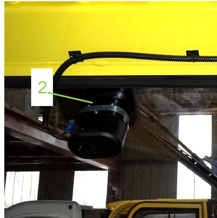
9. Repérer sur le faisceau fourni à l'aide du schéma électrique ci-dessus les connecteurs des différents moteurs d'essuie-glace
