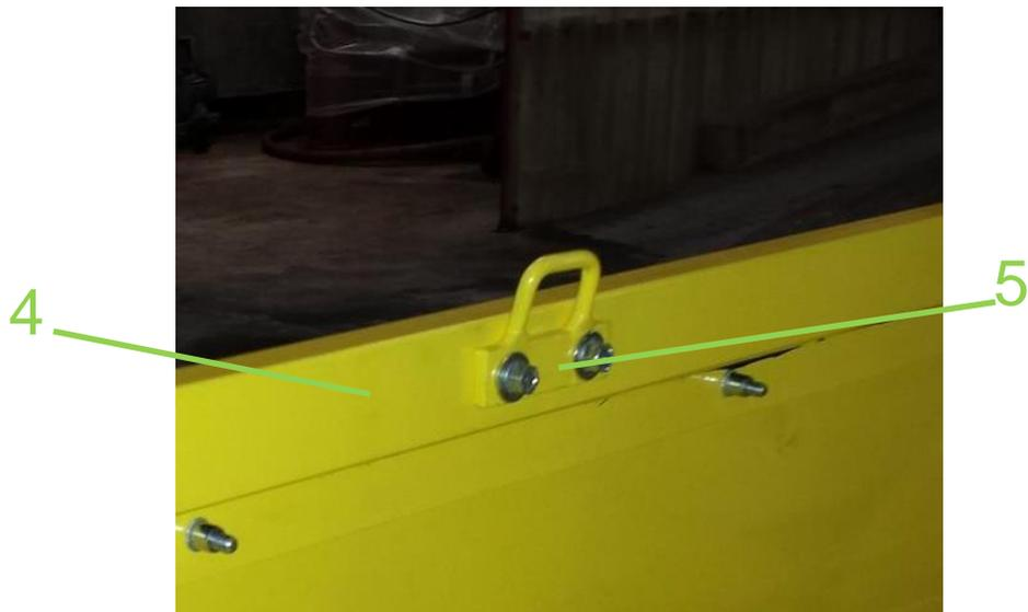
9. Fermer la vitre et positionner la gâche (5) de poignée arrière sur la traverse basse (4)
