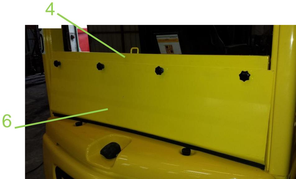
18. Fixer la tôle arrière basse (6) sur la traverse (4) à l'aide de 4 boutons moletés et des rondelles plates
