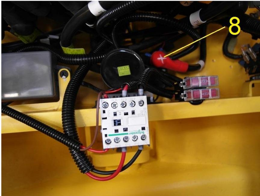
8. Raccorder le positif du faisceau du chauffage sur le point (8)
