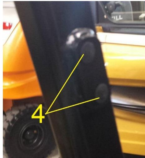
3. Retirez les bouchons plastiques (3) et (4) des trous d'origines
