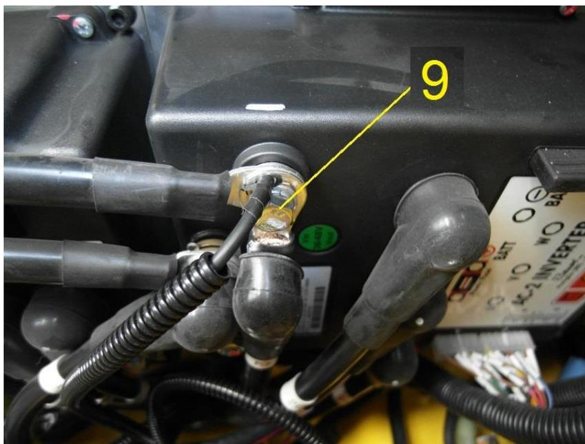
9. Raccorder le fil négatif du chauffage au point (9)
