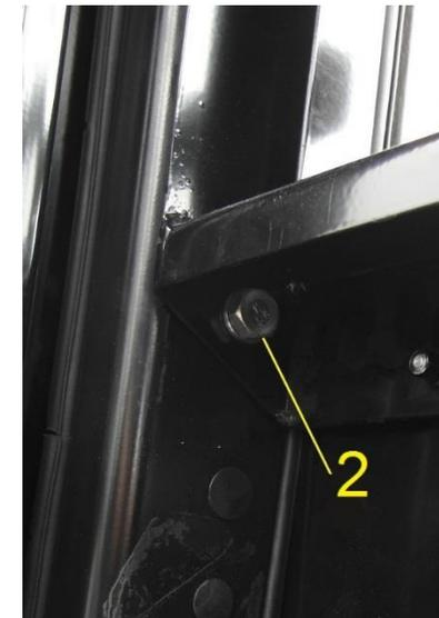
4. Fixer en bas du panneau arrière à l'aide des boutons moletés la tôle arrière basse (4)
