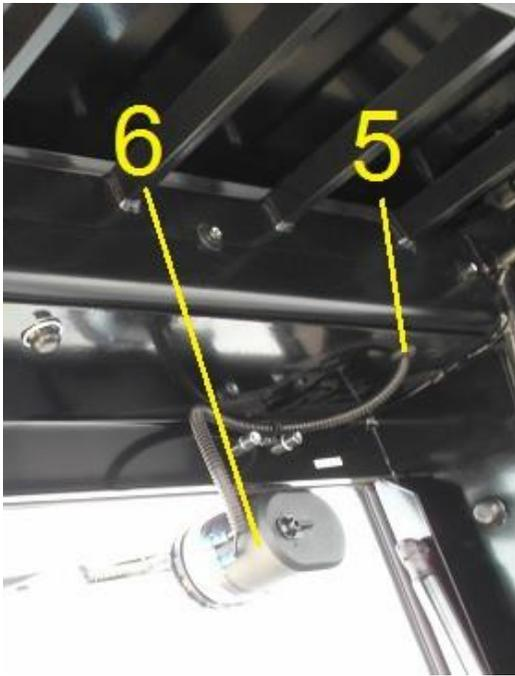
10. Tirer le faisceau électrique du moteur d'essuie-glace arrière le long de la batterie (suivre le faisceau d'origine) et le faire remonter par le montant arrière gauche. Faire sortir le faisceau par le point (5)
