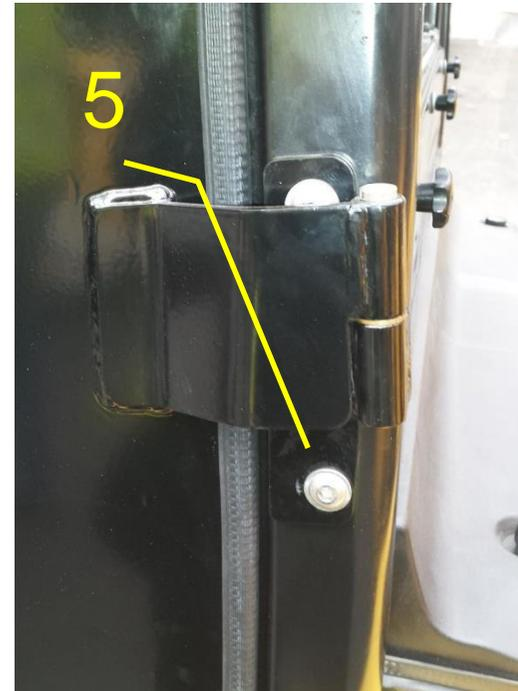
6. Monter la porte sur les charnières (5). Positionner la de façon à avoir un jeu régulier entre la porte et le protège conducteur. Vérifier que le joint plaque tout le tour de la porte
