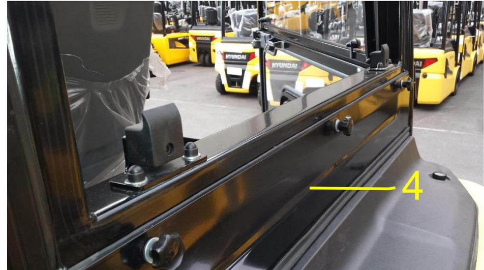
5. Finaliser l'étanchéité du panneau arrière en réalisant un masticage entre le cadre métallique du panneau arrière et le protège conducteur du chariot (Voir les traits rouge sur la photo ci-contre)
