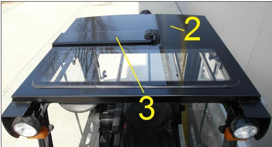
2. Poser le toit (2) sur haut du protège conducteur et positionner le suivant le passage pour l'accès aux batteries (3). Repartir le jeu latéralement de manière égale.
