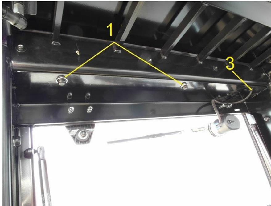
3. Présenter le panneau arrière entre les montants arrière du protège conducteur, et le fixer avec 2 vis HM10x25 et 2 vis HM8x20 et des rondelles plates
