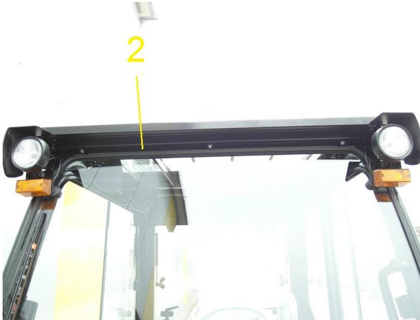
4. Fixer la traverse avant haute (2) avec 3 vis HM8X20 et des rondelles plates
