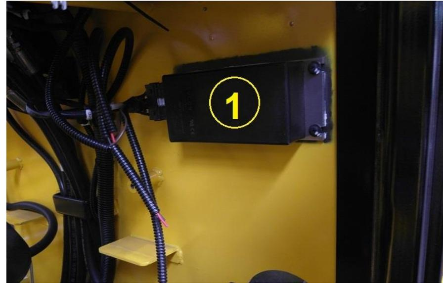
5. Dérouler le faisceau électrique fourni et repérer les différents connecteurs des équipements électriques fournis suivant le schéma du faisceau au point 1
