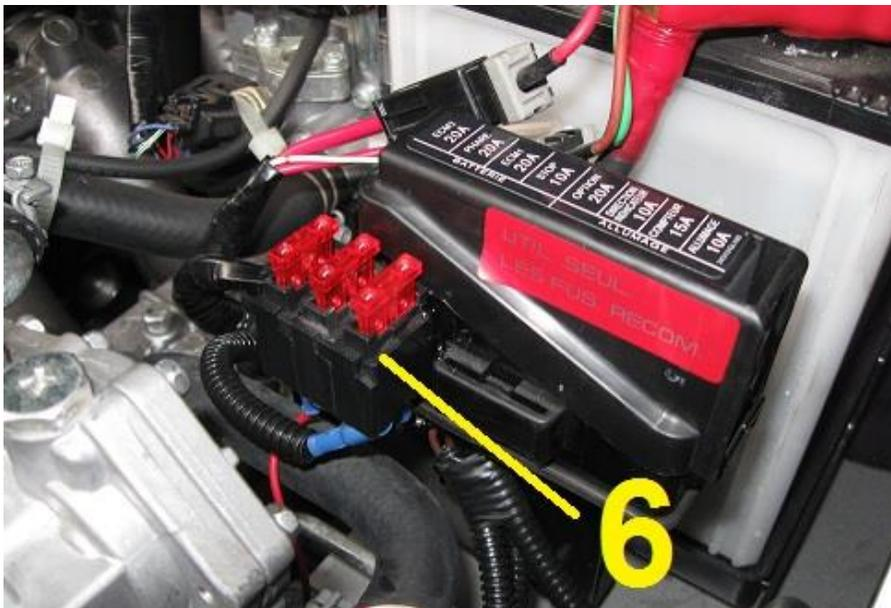
1. Positionner le support fusible fourni (6) contre le boîtier fusible d'origine
