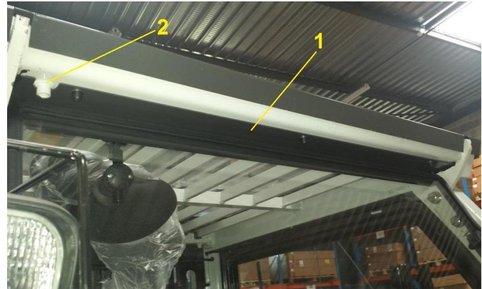
4. Positionner les traverses latérales (3) et (4) contre la face intérieure des montants avant du protège conducteur. Les traverses doivent être positionnées afin que les surfaces d'appuis de la vitre soient dans le même plan que la surface d'appui de la traverse supérieure (1) et que la partie basse de ces cornières en contact avec la tôle avant du chariot (5)
