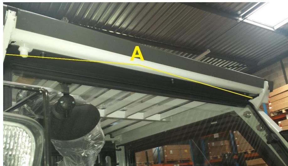
7. Présenter la vitre avant contre les surfaces d'appuis des tôles (1), (3) et (4) puis fixer la vitre sur les pattes de fixation prévues sur les tôles (3) et (4) à l'aide de la visserie fournie et en respectant le croquis ci-contre
