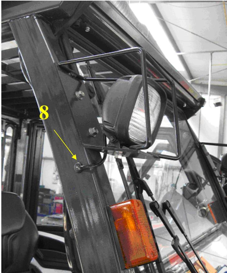
13. Visser la poignée de fixation de l'halogène arrière (9) à la partie supérieure du toit à l'aide des clous de Parker Ø6,3x25
