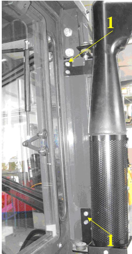
2. Visser la tôle inférieure sur le cadre arrière à l'aide des vis M6x20.
