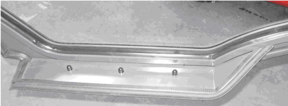
14. Visser la poignée de fixation au miroir (9). Apposer le miroir avec la poignée du côté droit et gauche intérieur du profilé avant du cadre du chariot de cette façon pour que le miroir assure une bonne visibilité vers l'arrière. Marquer les points pour les trous de montage sur le cadre du chariot. Forer les trous Ø11 et mettre les rivets à jaquette M8. Visser la poignée de fixation sur le cadre du chariot à l'aide des vis M8x25.
