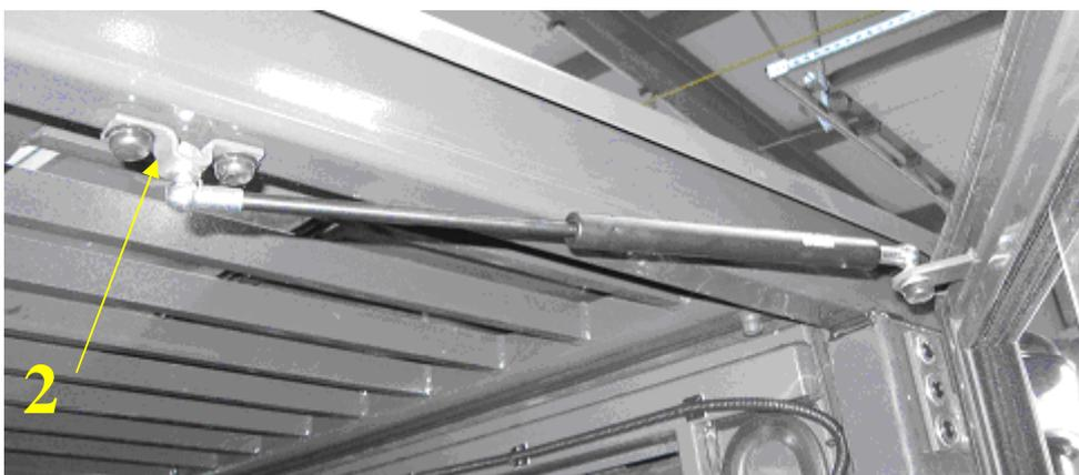
9. Quand la porte est fermée marquer sur la partie antérieure du cadre du chariot le point du montage de la fixation (3) du verrou. Sur les points marqués forer les trous  $\varnothing 11$  et y mettre les rivets à jaquette M8. Visser la fixation de l'axe d'articulation au cadre à l'aide des vis M8x25.
